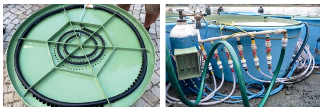
Obr. 3: Umístění aerační a oxygenační hadice pod dnem vložky (vlevo) a regulace rozvodu kyslíku a vzduchu pro jednotlivé kádě (vpravo).
