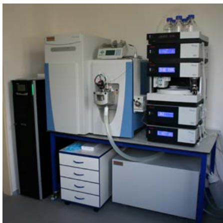
Obr. 6: Vysokorozlišovací tandemový hmotnostní spektrometr Q Exactive s UHPLC chromatografem od f. Thermo-Fisher Scientific (zdroj: V. Dvořáček)
