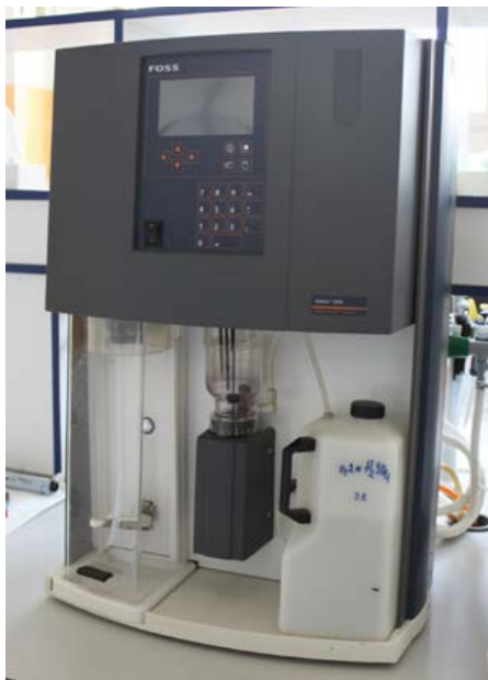
Obr. 2: Aparatura pro Kjeldahlovu analýzu f. FOSS (zdroj: V. Dvořáček): A) mineralizační a B) destilační jednotka
