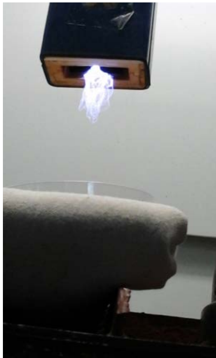
Obr. 4: Záběr na elektrický výboj generátoru plazmy typu Gliding-Arc. Výboj je proudem nosného plynu (kyslík, dusík, atd.) hnán do Petriho misky (ve spodní části snímku), ve které je umístěno ošetřované osivo.
