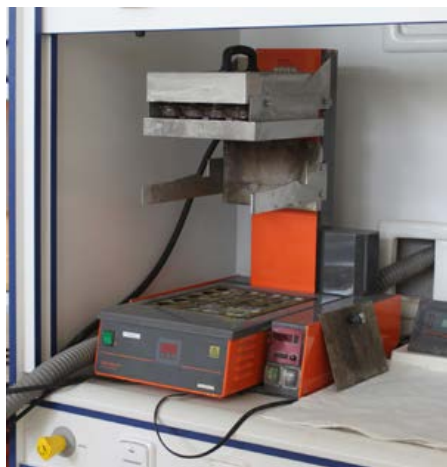
Obr. 2: Aparatura pro Kjeldahlovu analýzu f. FOSS (zdroj: V. Dvořáček): A) mineralizační a B) destilační jednotka
