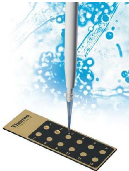
Obr. 8: Speciálně upravené vzorkové terčiky s nanovrstvou vzácných kovů pro analýzu SERS pomocí Ramanovy spektrometrie od f. ThermoFisher Scientific (zdroj: http://www.nicoletcz.cz/slers )
