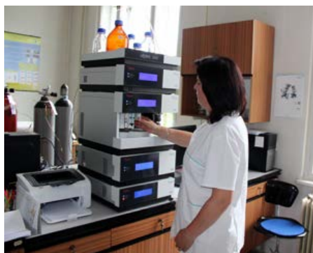
Obr. 6: Vysokoučinný kapalinový chromatograf firmy Thermo Scientific, typ Dionex UltiMate 3000 s DAD detektorem
