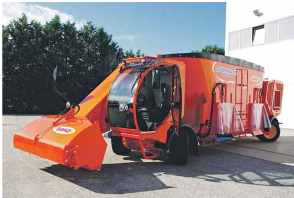
Samojízdný vůz SEKO se vyrábí ve dvou variantách – horizontální a vertikální míchání.
