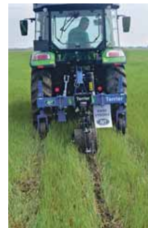
Terrier z dílny P&L slouží k pokládání rhodenticidů proti hrabošům
