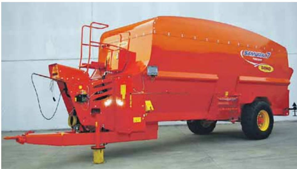
Také vyšší model SEKO Samurai 7 disponuje horizontálními míchacími šneky.
