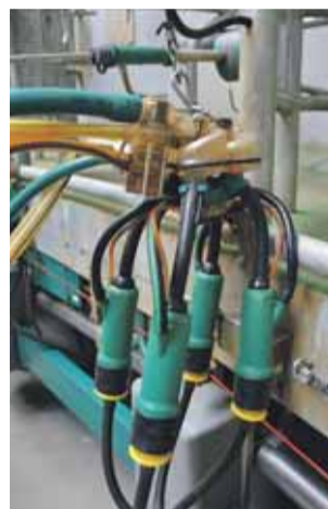
Strukové návlečky jsou jedinou částí dojícího zařízení, které se přímo dotýká krav.
