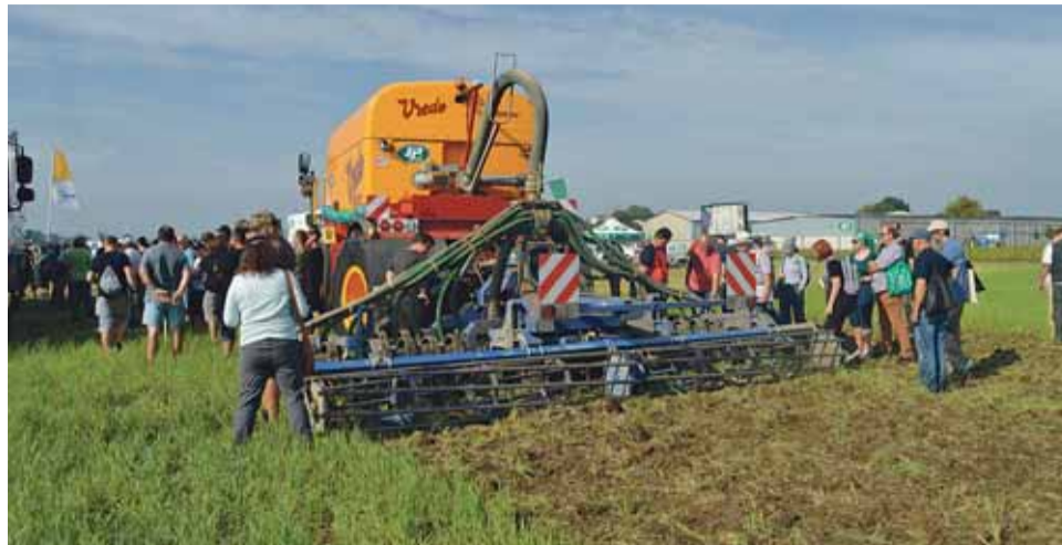
Diskový aplikátor kejdy Koeckeling Rebel Classic v agregaci s cisternou kejdy Vredo
