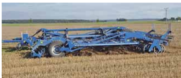
Kypřič Allrounder –flatline- je určen pro zpracování půdy v hloubce od 4 do 13 cm.
