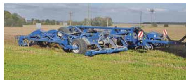
Díky výborné průchodnosti nedochází k ucpání stroje rostlinnými zbytky.
