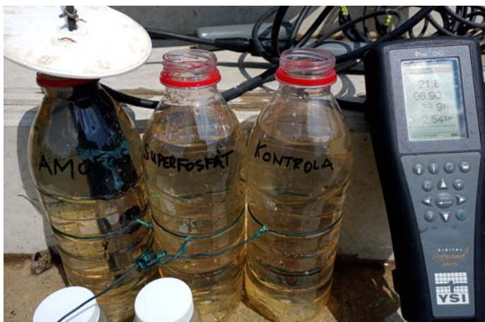
Obr. 5: Měření rozpuštěného kyslíku po dvouhodinové expozici bez významného nárůstu (negativní test).
