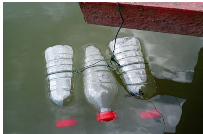
Obr. 4: Zavěšené kontrolní lahve se vzorky (Amofos, superfosfát, kontrola) na hladině sledovaného rybníka.
