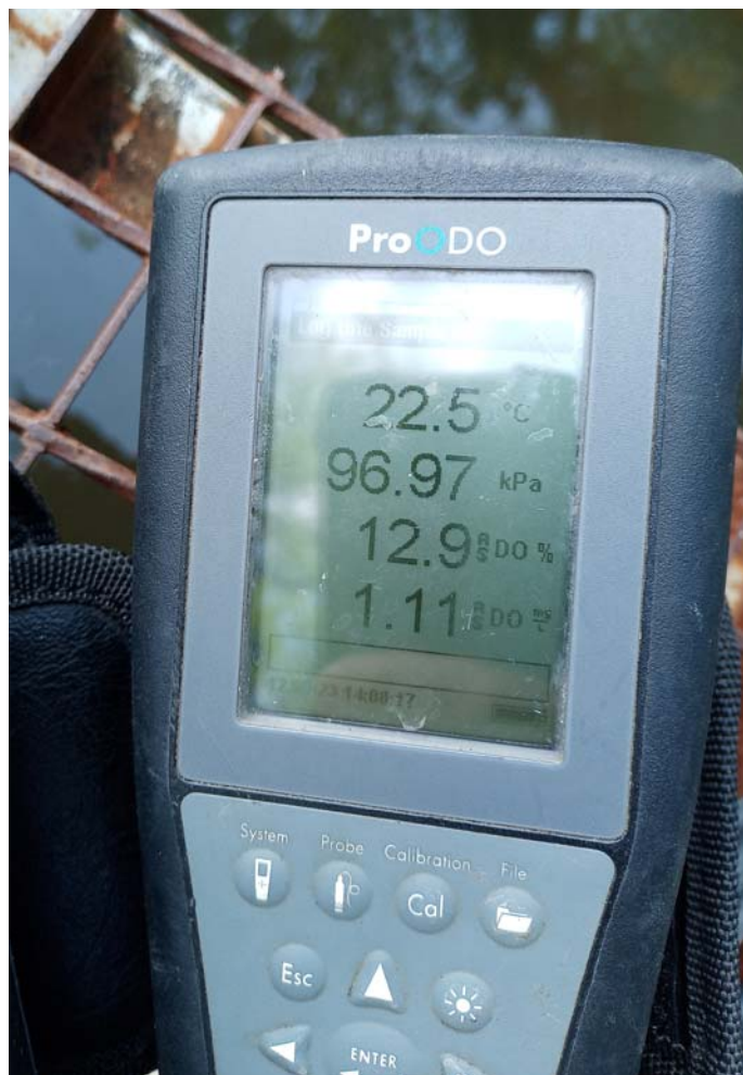
Obr. 7: Nízké množství rozpuštěného kyslíku ve vodě v průběhu celého dne může indikovat oprávněnost aplikace superfosfátového hnojiva.
