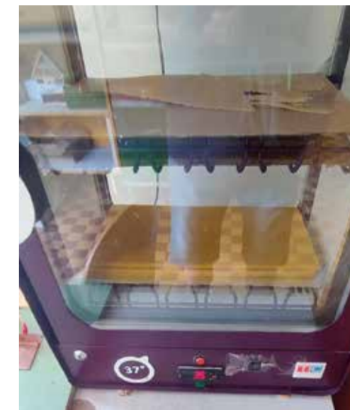
Snadnější se zatavují mezistěny nahřáté v termoboxu.
