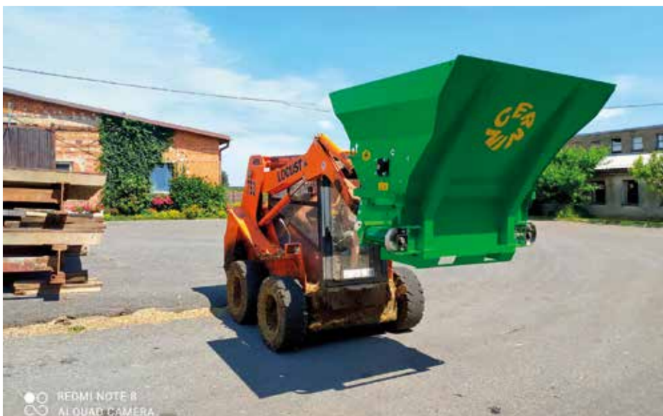
Zastýlací a krmené lžice jsou univerzálním řešením, které poslouží jak k zastýlání separátu či slámy, ale také ke krmení zvířat senáží, siláží nebo jadrným krmivem.
