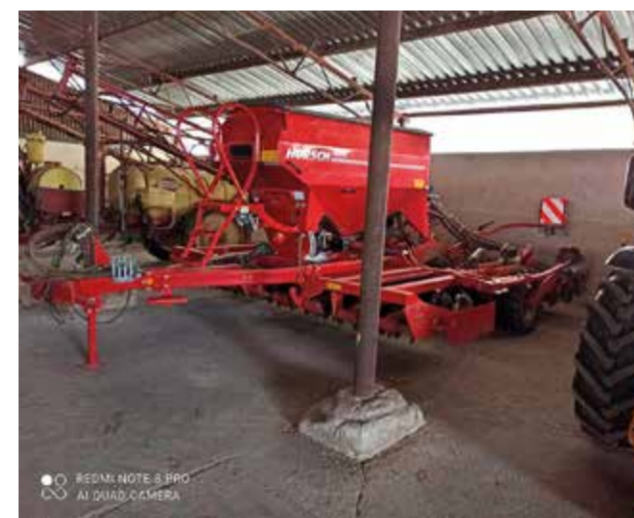
Secí kombinace HORSCH Pronto 4 DC, 28řádková o záběru 4 m Foto: Palásek, 2024
