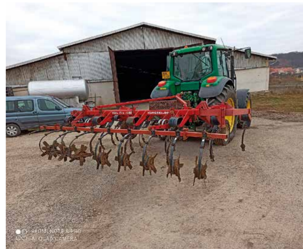
Traktor JOHN DEERE 6420 Premium o výkonu 115 koní s radičkovým podmiřičem Kongskilde se záběrem 4 m Foto: Palásek, 2024
