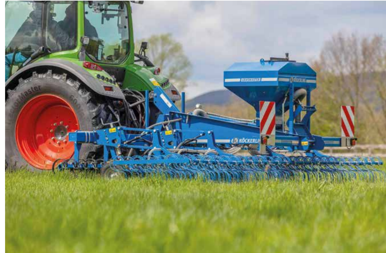
Luční brány Köckerling Grasmaster nekompromisně vyvláčejí starou trávu, srovnají pozemek po krutích a rozryté plochy po lesní zvěři, eventuelně dosejí poškozené plochy. Mohou se použít i pro vláčení plevelů v jařních.
