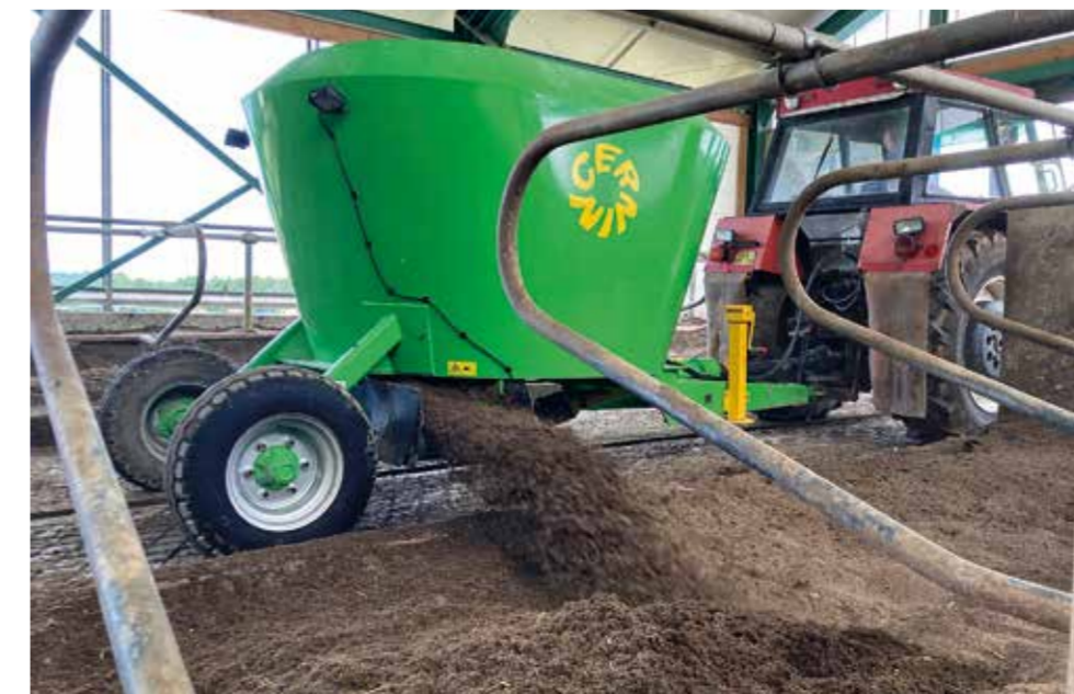
Model NZ od Cerninu si hravě poradí se zastýláním separátů. V družstvu 2x týdně zastele 508 boxových lóží.
