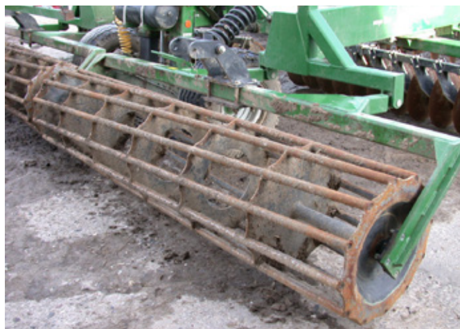
Obr. 131: Prutové válce jsou rovněž standardní součástí radličkových kypřičů a talířových podmítačů (foto Brant).
