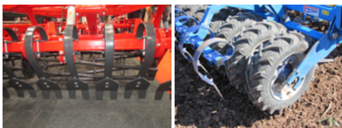
Obr. 125: Stroje kombinující více pracovních operací při předseťové přípravě nebo secí stroje vybavené pracovními sekcemi pro souběžnou předseťovou přípravu a setí jsou osazovány smyky tvořené řadou smykových destiček s nastavitelným úhlem (foto Brant).
