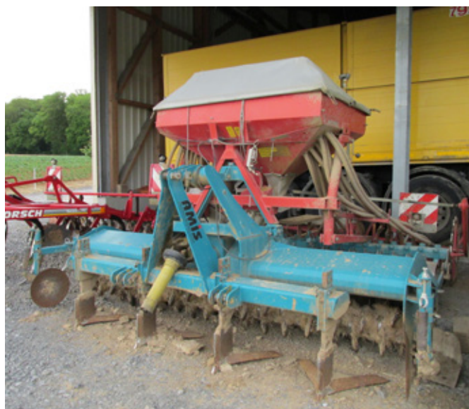
Obr. 46: Kombinované kypřiče osazené secím strojem umožní založit porosty pomocí jedné pracovní operace (foto Brant).
