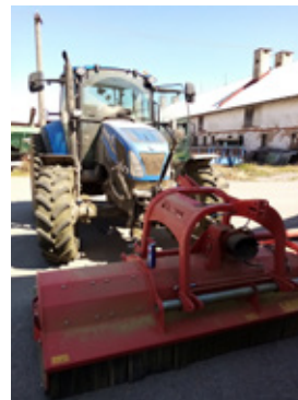
Obr. 267: Čelně nesený mulčovač s horizontální osou rotace pracovních nástrojů s pracovním záběrem 3 m používaný pro regulaci porostů meziplodin (foto Brant).
