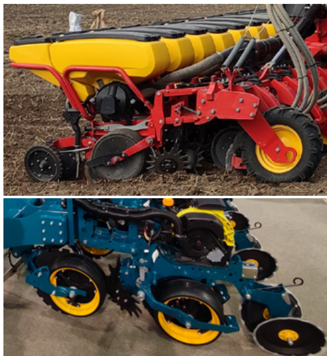
Obr. 117: Pro odstranění rostlinných zbytků (především sláma předplodiny) je vhodné osadit výsevní sekci odhrnovači rostlinných zbytků (foto Brant).
