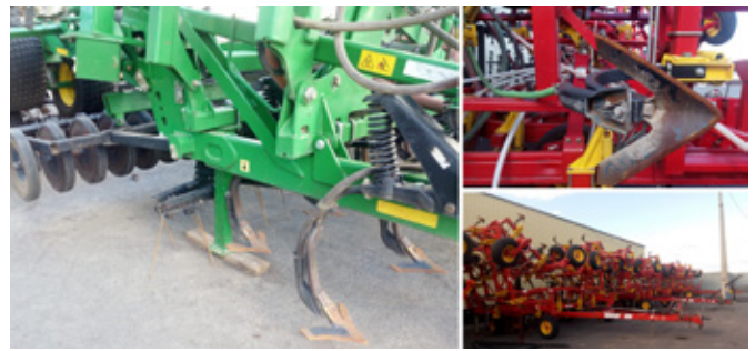
Obr. 222: Secí stroje ukládající hnojivo za plochou výsevní radličku, Kazachstán (foto Brant).
