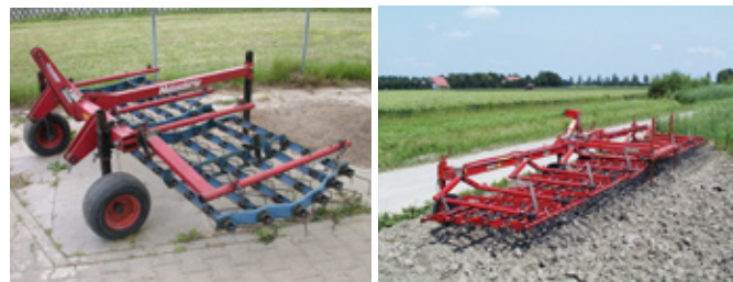
Obr. 279: Kypřící a odplevelující efekt zajišťují pružné pruty umístěné v několika řadách na rámu stroje (foto Brant).
