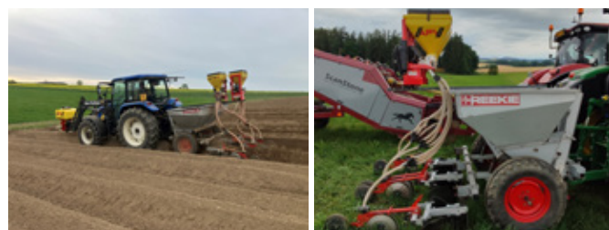
Obr. 366: Výsadba brambor dvouřádkovým sazečem do záhonů vyseparované půdy se souběžnou aplikací hnojiva z čelního zásobníku umístěném na traktoru a výsev směsi pomocné plodiny do mezihrůbků. Zásobníky osiva jsou umístěny na sazeči. Z jednoho zásobníku jsou dávkována malá semena a z druhého semena větší, aby nedocházelo k jejich nerovnoměrnému zastoupení ve směsi při segmentaci ve společném zásobníku. Semenovody z jednotlivých zásobníků jsou svedeny do jedné výsevní botky (foto Holejšovský a Brant).
