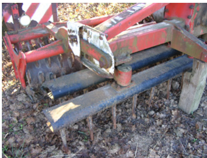
Obr. 147: Kývavé brány nedostatečně drtí hroudy a méně zapravují rostlinné zbytky (foto Brant).
