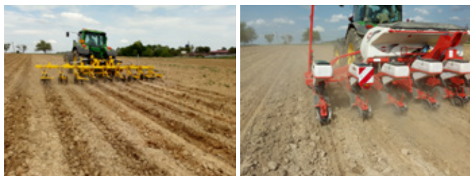
Obr. 152: Po provedení pásové přípravy s přihnojením do kypřeného pásu následuje setí (vpravo) s možností hnojení jiným hnojivem k řádku rostliny (foto Brant).
