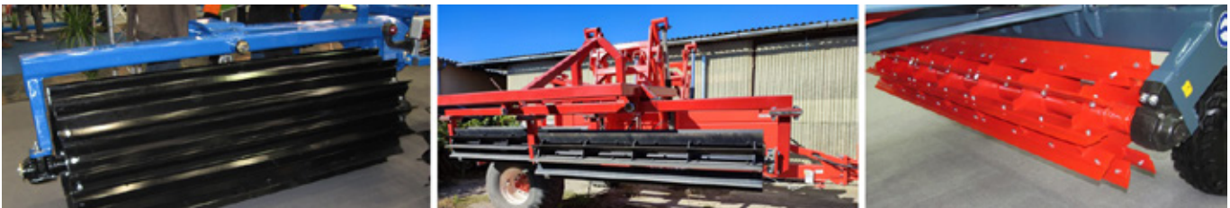
Obr. 262: Pro zpracování strniště jsou vhodné stroje o větším záběru, které lze zařadit do kategorie tažených strojů (foto Brant).
