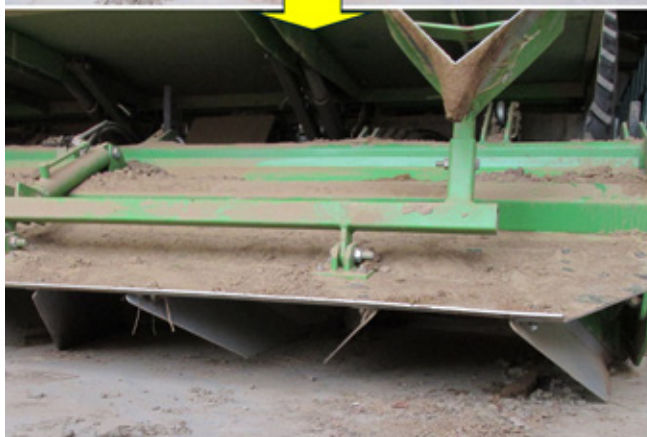
Obr. 367: Souprava pro výsadbu brambor složená ze sazeče brambor a čelně neseného rotačního kypřiče pro souběžné zpracování půdy a sázení (foto Brant).
