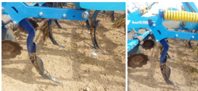
Obr. 92: Pro provedení podrývání lze použít kypřiče s možností nastavení variabilní hloubky poslední řady kypřičích nástrojů (foto Brant).
