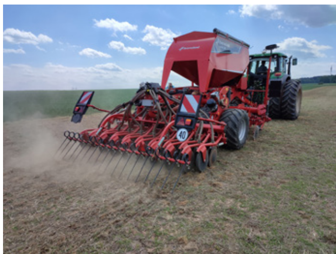
Obr. 12: Pro výsev meziplodin do strniště zrnin lze při systému využití biologického zpracování půdy nahrazujícího podmítka využít secí stroje pro setí do nezpracované půdy (foto Brant).
