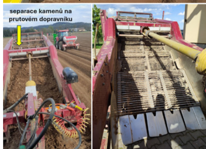
Obr. 365: Separace půdy pomocí prosevačů, kde dochází k vyseparování kamenů z půdy a k jejich uložení do prostoru mezi budoucí dvouhrůbky (foto a zpracování Holejšovský a Brant).
