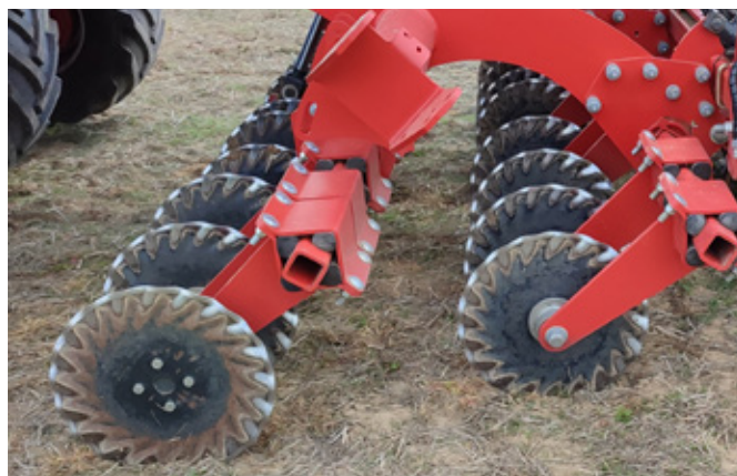
Obr. 214: Kvalitní práci secí botky a rychlejší ohřev povrchové vrstvy půdy lze zajistit zpracováním půdy pomocí řezných talířů se zvlněným okrajem (foto Brant).
