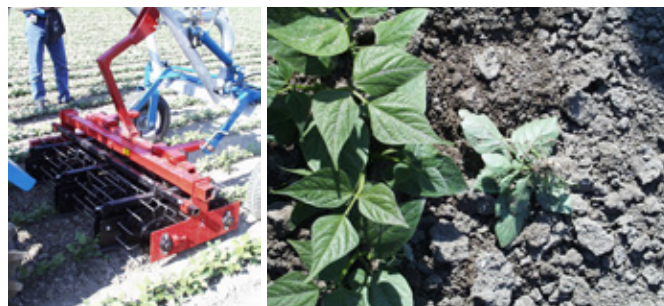
Obr. 307: Jedním z příkladů speciálních konstrukcí je systém prutových válců, který při průchodu kyprou půdou vytrhává plevelné rostliny i s kořenovým systémem a rostliny ukládá na povrch půdy (foto Brant).
