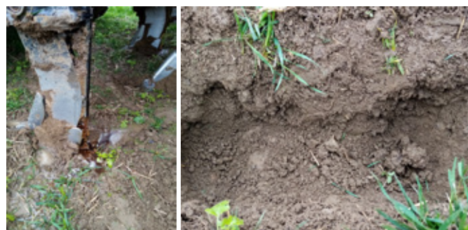
Obr. 38: Kypřicí radlice osazené křídly rovněž zajišťují dobré prokypření půdního profilu (foto Brant).
