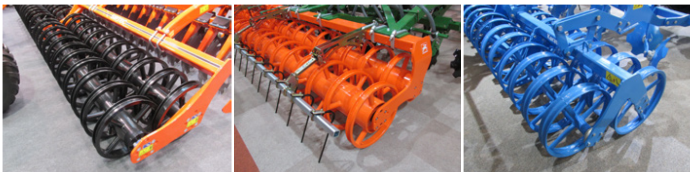
Obr. 135: Principem U-válců je osazení pěchovacích kol po obvodu tzv. U-profilem (foto Brant).
