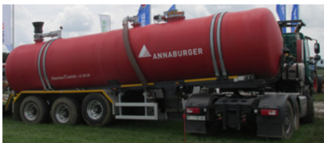
Obr. 345: Automobilové návěsy umožňují transport velkých objemů tekutých hnojiv a umožňují plnění nádrží aplikátorů z komunikace. Problémy však může činit jejich stání na komunikaci při přečerpávání hnojiv (foto Brant).
