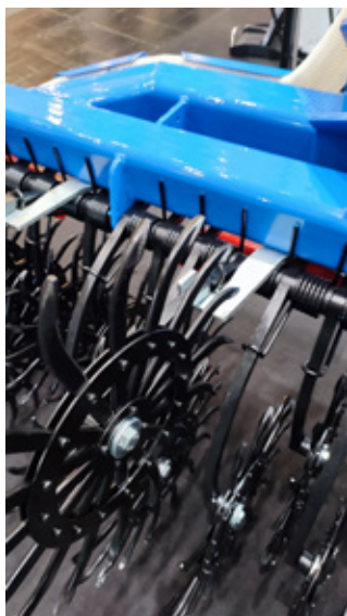
Obr. 288: Značná část konstrukčních řešení umožňuje rychlé a jednoduché vyrazení jednotlivých hvězdicových kol z pracovní polohy, čímž lze stroje upravit pro meziřádkovou kultivaci (foto Brant).
