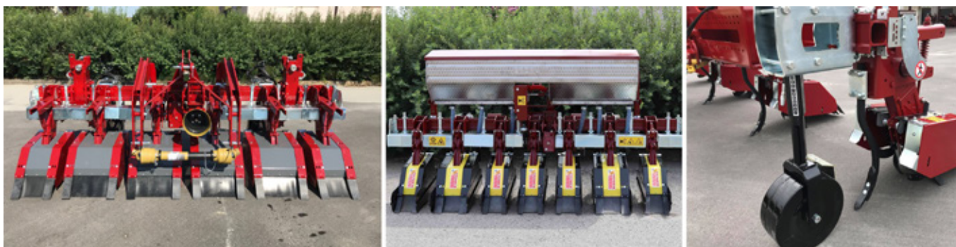
Obr. 305: Konstruktivní řešení umožňují volbu kypřících sekcí v rozdílných záběrech ve vztahu k rozteči pěstovaných plodin (zdroj Badalini, https://www.badalini.it/ ).
