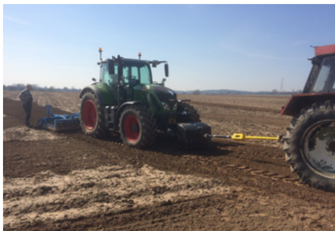
Obr. 424: Měření potřeby tahových sil pro vybrané druhy nářadí s využitím dynamometru, které je umístěn mezi traktory (foto Kroulík).
