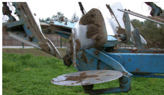
Obr. 66: Umístění předradličky před orebním tělesem, ve spodní části fotografie je patrné kotoučové krojídlo (foto Brant).
