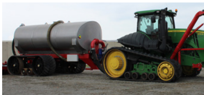
Obr. 337: Náhrada pneumatik u tažných prostředků a zásobníků tekutých hnojiv pásy (foto Kroulík).
