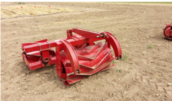
Obr. 269: Pro technologii ozeleněných trajektorií je vhodnější použít řezné válce se možností změny záběru, které lze dobře přizpůsobit požadovaným podmínkám zemědělského subjektu (foto Brant).
