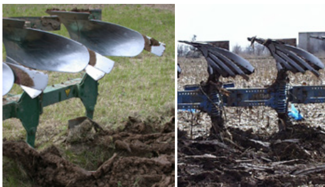
Obr. 64: Orba pomocí orebních těles s plnými odhrnovačkami a střížnou pojistkou (vlevo) a odhrnovačkami páskovými s automatickou pojistkou s tlačnými pružinami (vpravo), foto Brant.
