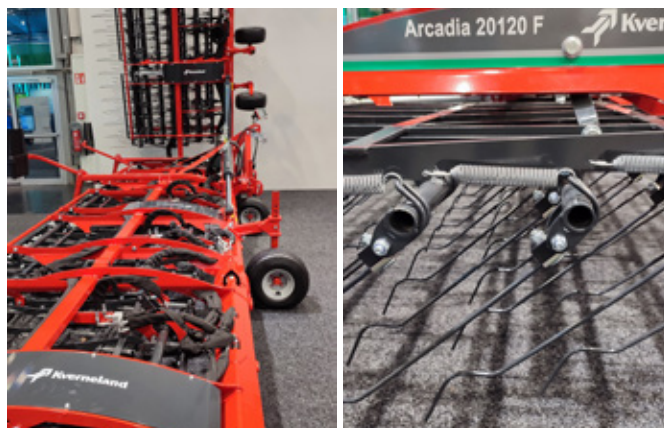
Obr. 284: Na trhu jsou komerčně dostupné i konstrukce prutových bran se sekční kontrolou jednotlivých pracovních sekcí, které omezují opětovné provedení operace na klínovitých částech pozemku apod. (foto Brant).
