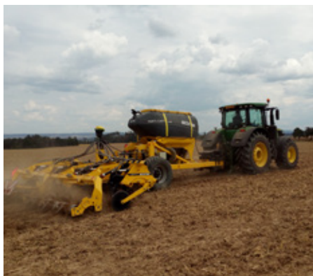
Obr. 45: Stroje pro hlubší diferencované zonální kypření zajišťují hlubší prokypření půdy v místě budoucího řádku rostlin a zároveň i intenzivnější mělké kypření horní vrstvy půdy i mezi hlouběji pracujícími radlicemi (foto Brant).
