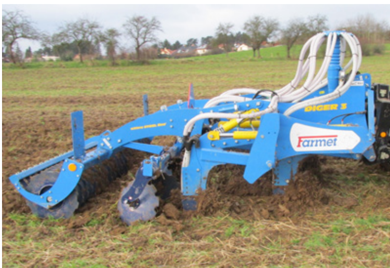
Obr. 43: Kypřiče s poloparabolickými slupicemi umožňují kvalitní kypření i při vyšších vlhkostech půdy. Za sucha je kypřicí efekt velmi intenzivní, ale hrozí riziko vzniku větších hrud a mezipůdních prostor ve spodních částech ornice (foto Brant).
