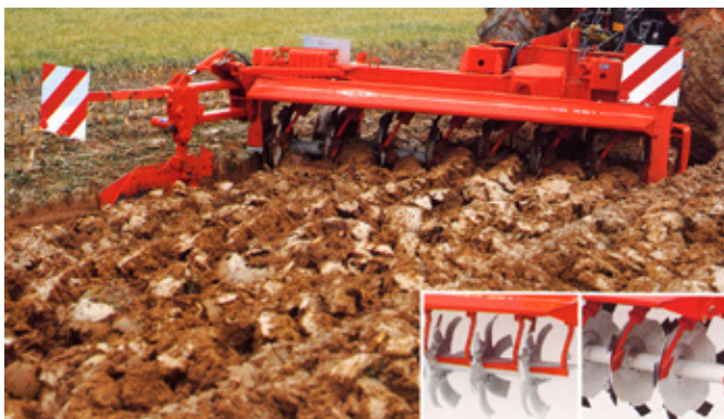
Obr. 71: Rotační pluhy jsou určeny pro zpracování těžkých půd (foto KUHN, https://www.kuhn.com/ ).
