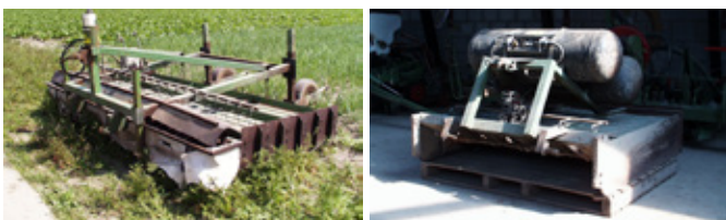
Obr. 277: Termické plečky jsou v praxi dlouhodobě využívány především v ekologickém zemědělství a při pěstování zeleniny (foto Brant).
