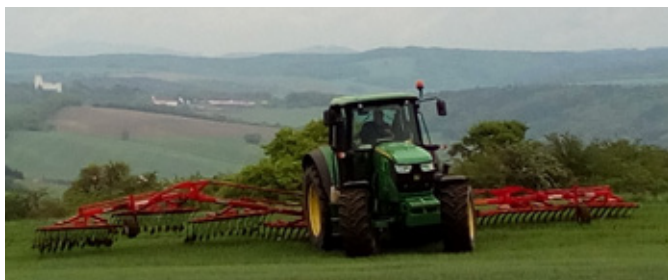
Obr. 281: Při pohybu šikmo na směr řádků obilniny dochází k tvorbě postranních pseudosouvratí při otáčení soupravy mimo standardní souvrat' (foto Brant).
