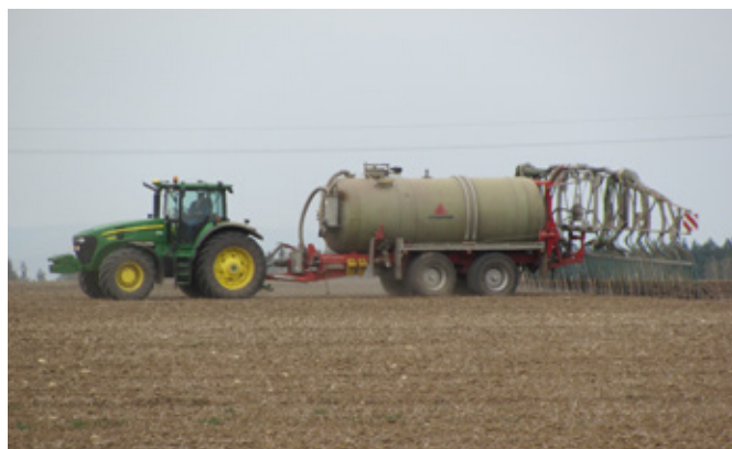
Obr. 346: Cílená povrchová aplikace pomocí hadicového aplikátoru (foto Brant).
