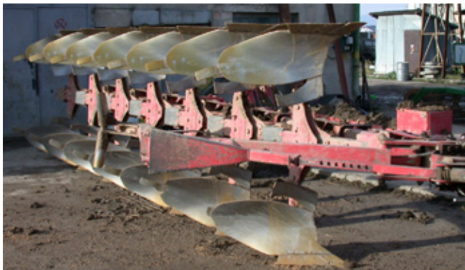
Obr. 69: Oboustranný radličný pluh se zařízením pro uchycení půdního pěchu (foto Brant).
