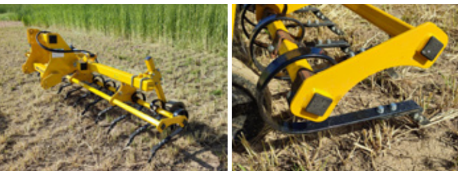
Obr. 29: Stroje s řeznými dláty lze efektivně využít pro provedení podmítky v systémech setí do nezpracované půdy (foto Brant).
