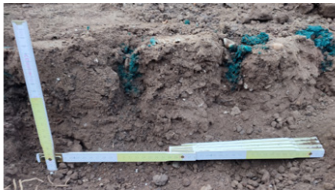
Obr. 328: Stav infiltrace kapaliny do půdy při použití aplikačních jehel s plochým zakončením při aplikaci do vlhké půdy (foto Kroulík).
