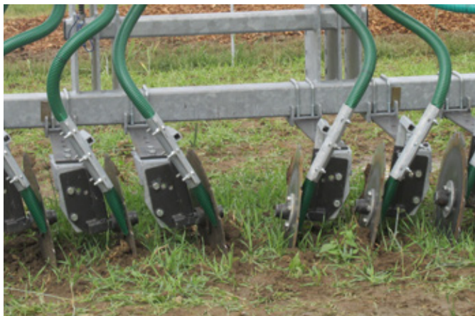
Obr. 352: Systémy otevření půdy pomocí šikmo postavených talířů (foto Brant).
