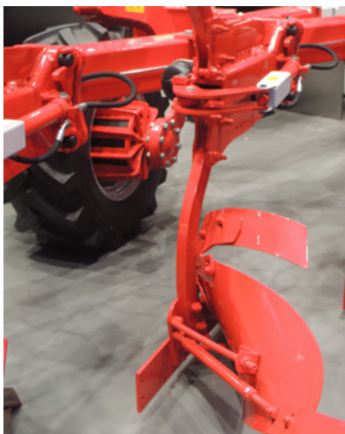
Obr. 77: Pomocný elektromotor v náboji kola pluhu pro zajištění účinnější trakce a snížení prokluzu traktoru (foto Kroulík).
