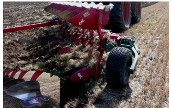
Obr. 30: Při použití pluhů s menším záběrem orebního tělesa jsou posklizňové zbytky a sláma dokonale zapraveny do půdy (foto Brant).
