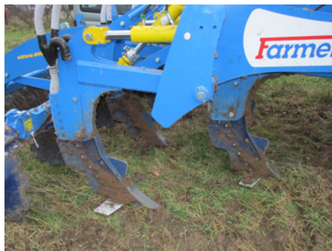
Obr. 232: Transportní cesty pro minerální hnojivo umístěné na kypřičí radlici (foto Brant).
