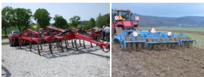
Obr. 42: Pomocí dlátových kypřičů lze provést hlubší zpracování půdy až do hloubky 0,35 m a dochází i ke kvalitnímu zapravení rostlinných zbytků do horních vrstev půdy (foto Brant).
