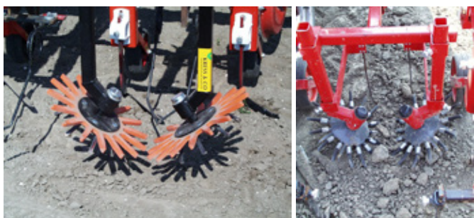
Obr. 309: Efekt intenzity průchodu odplevelujících prstů půdou je určován jejich délkou a tuhostí (foto Brant).
