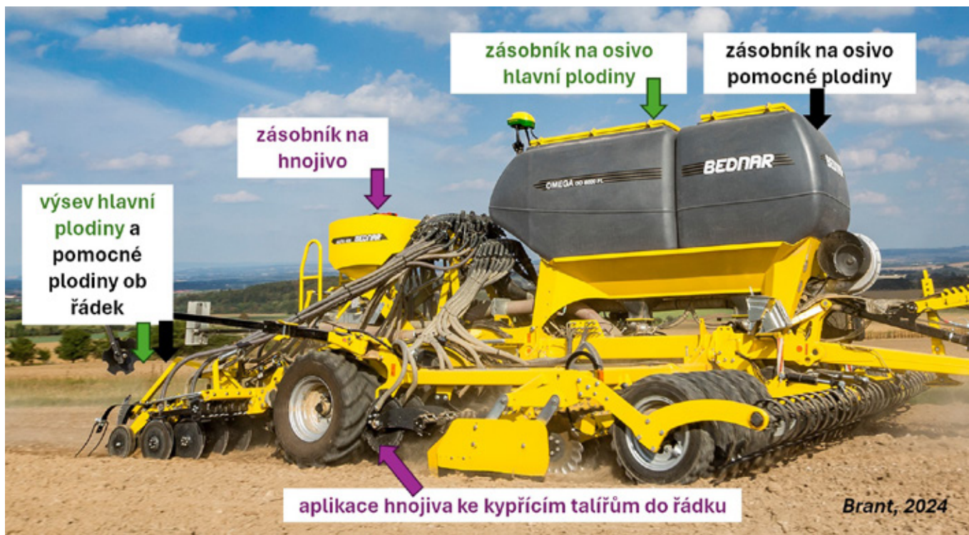
Obr. 240: Pomocí kypřících talířů lze aplikovat granulované látky (včetně minerálních a organických hnojiv) do požadované vzdálenosti a hloubky od seťového lože hlavní plodiny (foto a zpracování Brant).
