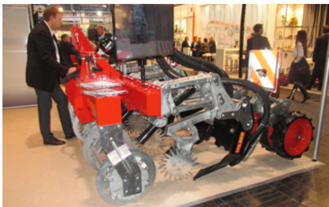
Obr. 357: Kypřiče s bočně zahnutou deskovou slupicí zakončenou dlátem (foto Brant).
