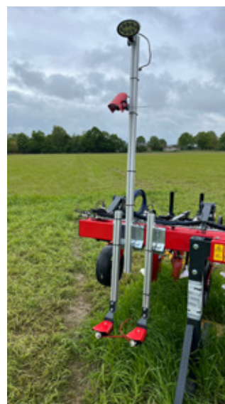
Obr. 321: Kombinace optického senzoru a mechanického hmatáče (foto KVERNELAND GROUP CZECH s.r.o., https://cz.kverneland.com/ ).
