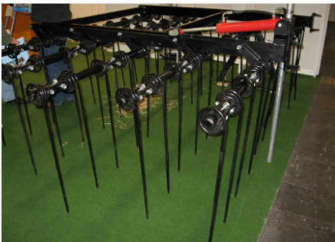
Obr. 23: Prutové kypřiče jsou určeny pro velmi mělké zpracování půdy do hloubky kolem 30 mm (foto Brant).
