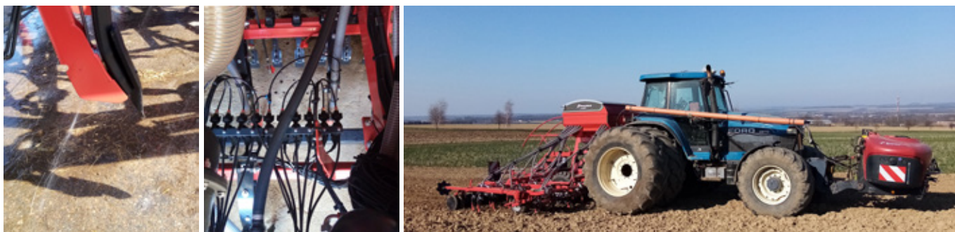
Obr. 244: Aplikace kapalných látek na osivo při seti za výsevní dlátovitou radličku (foto Brant).
