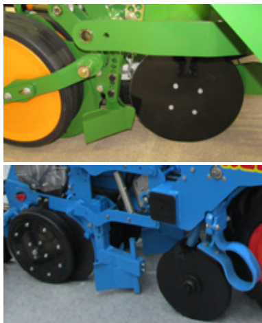
Obr. 116: Za účelem odstranění větších půdních agregátů z místa budoucího řádku plodiny se před výsevní talíře umísťují odhrnovače hrud (foto Brant).
