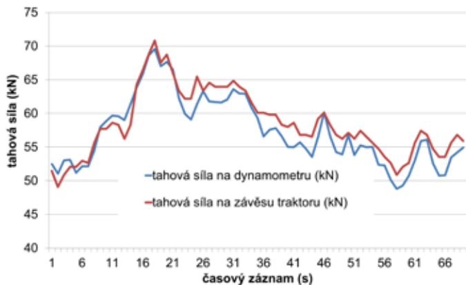
Obr. 434: Porovnání způsobů měření tahové síly (zdroj Kroulík).
