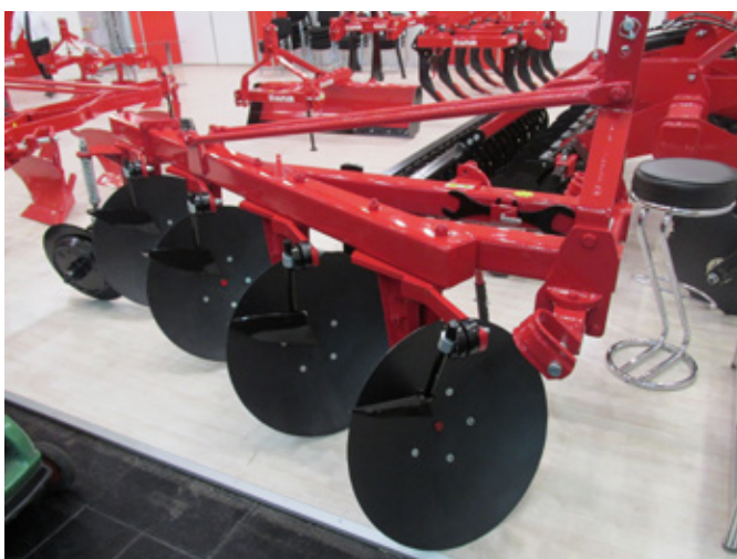
Obr. 72: Talířové pluhy se vyznačují jednoduchou konstrukcí, vykazují však ve srovnání s radličnými horší kvalitu zapravení rostlinných zbytků (foto Brant).
