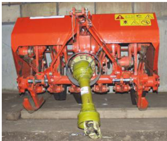
Obr. 73: Rýčový pluh využívající konstrukce „bod-hod“ (foto Brant).
