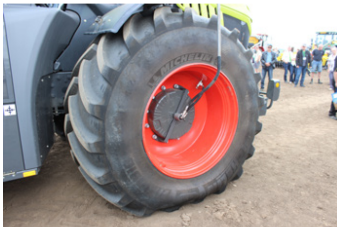
Obr. 442: Rozvody vzduchu pro úpravu tlaku v pneumatikách během práce stroje (foto Kroulík).
