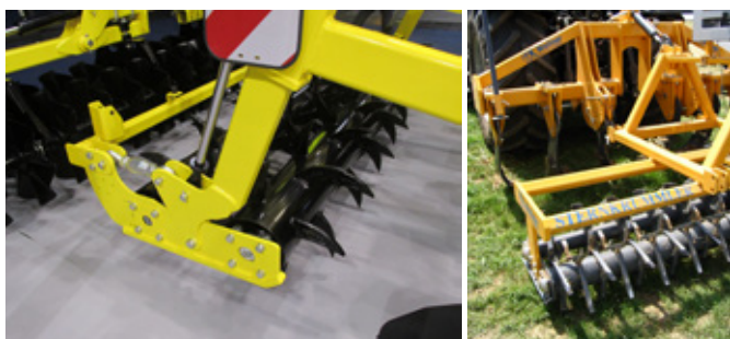
Obr. 138: U hřebových válců se tlak hrotů hřebů projevuje utužováním půdy ve spodnějších vrstvách (foto Brant).
