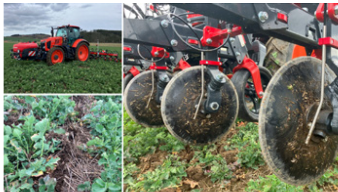
Obr. 335: Modifikace plečky pro aplikaci hnojiva za řezný disk k řádku ozimé řepky na jaře (foto Chára).
