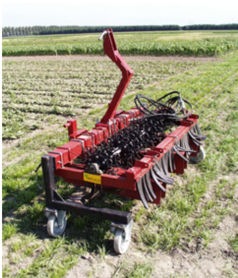
Obr. 292: Systémy s rotujícími pružnými pruty s horizontální osou rotace (foto Brant).
