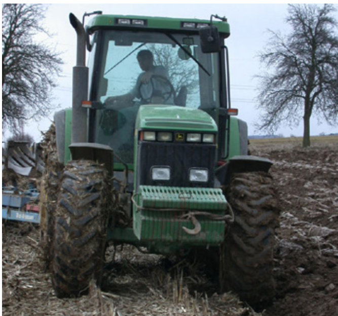
Obr. 75: Při orbě radličnými pluhy jede traktor jednou stranou kol v brázdě (foto Brant).
