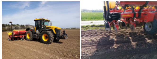
Obr. 178: Secí stroj pro přesné setí plodin do širokých řádků zakládající plodiny systémem dvouřádků, stroj na snímku je nastaven na rozteč středů dvouřádků 0,75 m, vzdálenost mezi řádky v dvouřádků je 0,25 m (foto Brant).
