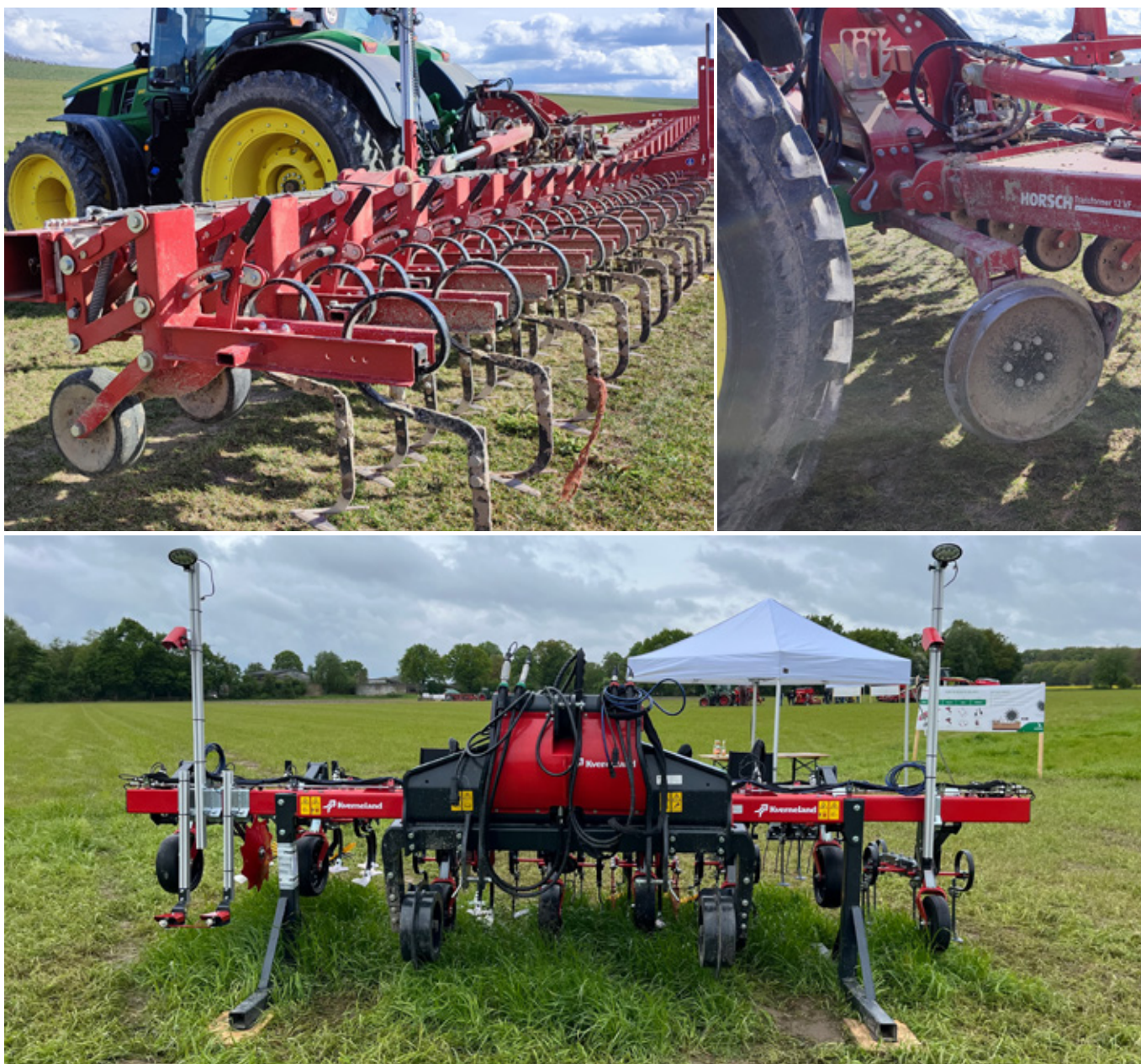
Obr. 327: Mezírám, zařazený mezi traktor a náradí, kompenzuje chybu v navádění příčným posunem náradí. Případné boční síly při posunu zachytávají ostruhová kola (foto Kroulík).
