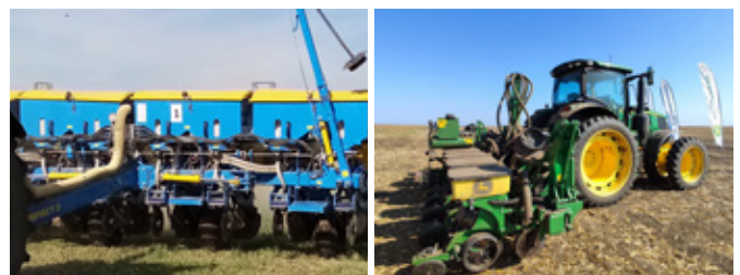
Obr. 225: Přesné secí stroje určené pro setí do nezpracované půdy se samozřejmě vyznačují robustní konstrukcí (foto Brant).
