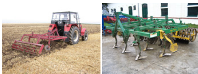
Obr. 16: Radličkové kypřiče se vyznačují velice dobrým mísicím efektem (foto Brant).
