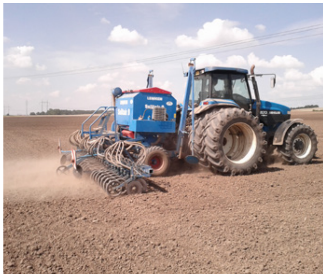
Obr. 168: Secí stroje bez sekcí pro přípravu půdy většinou vyžadují kvalitní předseťovou přípravu půdy (foto Brant).
