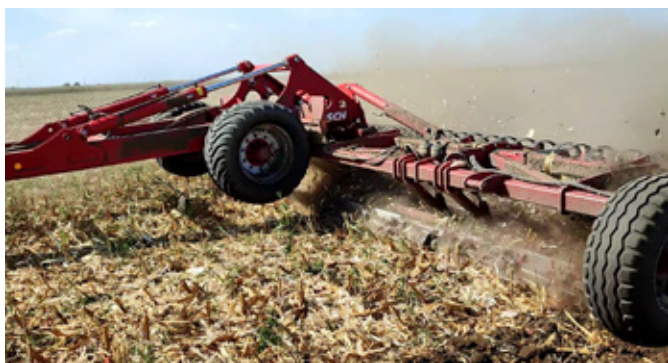
Obr. 216: Úprava strniště po sklizni zrnové kukuřice řeznými válci (foto Brant).
