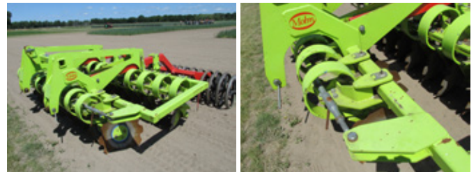
Obr. 21: U talířových kypřičů se stále můžeme setkat s konstrukčními řešeními, která umožňují změnu postavení pracovního úhlu u talířů za účelem optimalizace kvality práce (foto Brant).
