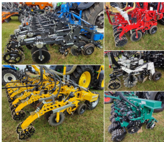
Obr. 198: Dominantní zastoupení v rámci střední Evropy mají konstrukční řešení využívající systém kypřicí radlice s kypřicími a omezovacími kotouči umístěnými na individuálně zavěšených kypřicích sekcích (foto Brant).
