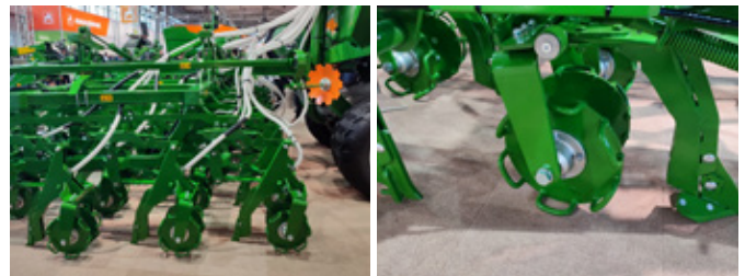
Obr. 224: Konstrukční řešení radličkových secích botek pro výsev do nezpracované půdy, které zajišťuje dobré kopírování povrchu půdy (foto Brant).
