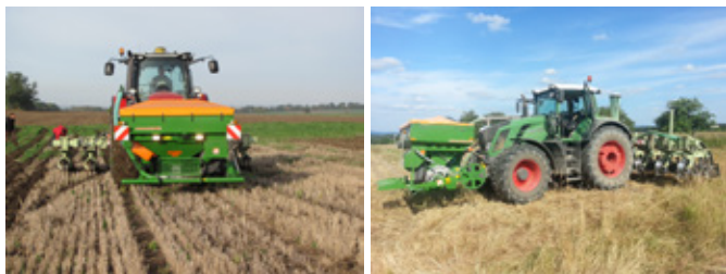
Obr. 236: Aplikace minerálních hnojiv do půdy za kypřicí nástroje pracovních sekcí kypřiče pro pásové zpracování půdy (foto Brant).
