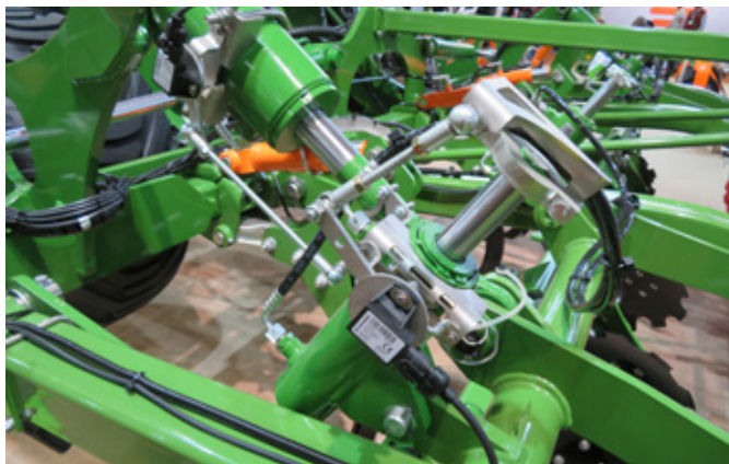
Obr. 325: Systémy kontroly činnosti a stavu nářadí (foto Kroulík).
