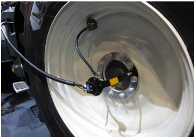
Obr. 418: Systém pro dofukování pneumatik stroj během jízdy (foto Kroulík).
