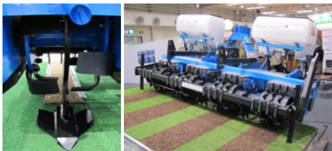
Obr. 205: Kypřicí radlička kypří půdu pod noži frézovací sekce (vlevo) a zpětné utužení půdy zajišťují dělené pěchovací válce (vpravo), foto Brant.
