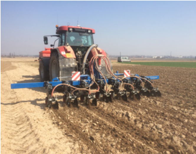
Obr. 426: Modifikovaný meziřádkový kypřič pro zonální přípravu a přihnojení pod osivové lůžko (foto Kroulík).
