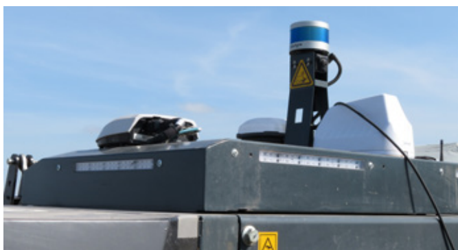
Obr. 323: Lidar umístěný na sloupku snímá v několika rovinách prostor okolo stroje (foto Kroulík).
