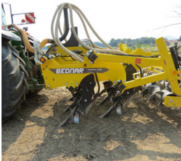
Obr. 43: Kypřiče s poloparabolickými slupicemi umožňují kvalitní kypření i při vyšších vlhkostech půdy. Za sucha je kypřicí efekt velmi intenzivní, ale hrozí riziko vzniku větších hrud a mezipůdních prostor ve spodních částech ornice (foto Brant).
