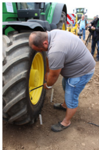
Obr. 443: Úprava tlaku v pneumatikách s pomocí ventilkou pro jeho rychlou úpravu (foto Kroulík).
