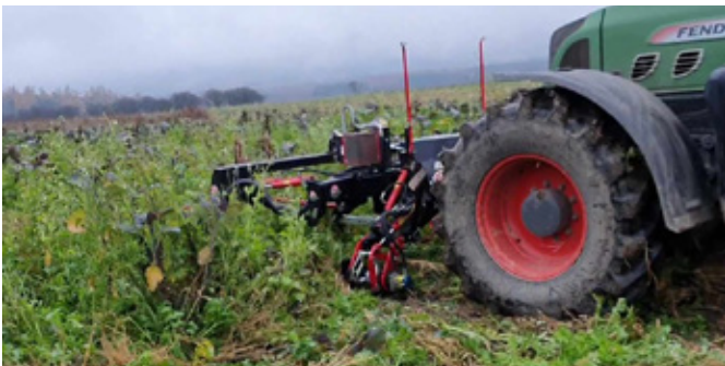
Obr. 268: Prstové žací lišty musí být jednoznačně umístěny čelně na tažném prostředku (foto Kranich).
