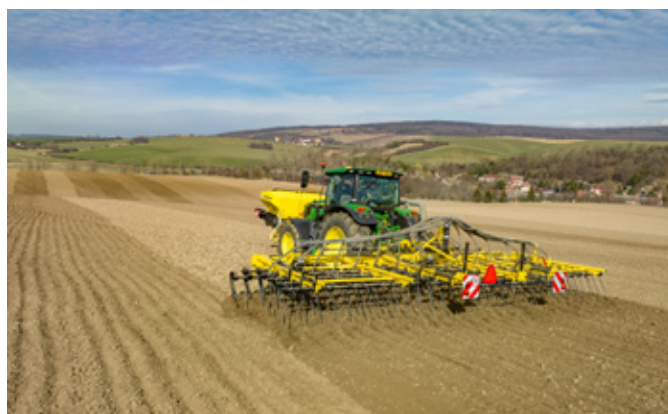
Obr. 167: V rámci podmínek evropského zemědělství jsou konstrukce modifikovány i pro časné jarní urovnání půdy po podzimním zpracování půdy. Na obrázku je kombinace dělených smykových desek s kypřicími pruty (foto BEDNAR FMT s.r.o., https://www.bednar.com/ ).
