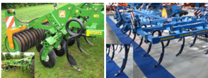
Obr. 22: Pro mělké zpracování půdy lze využít i dlátové kypřiče (foto Brant).
