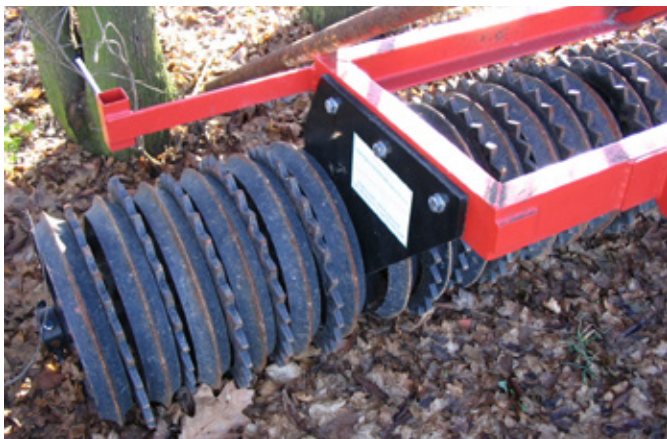
Obr. 129: Cambridgské válce lze také využít při ošetřování ozimů na jaře (foto Brant).
