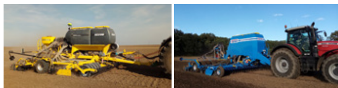
Obr. 169: Stroje se systémem přípravy půdy při seti využívající pasivně pracující pracovní nástroje (foto Brant).
