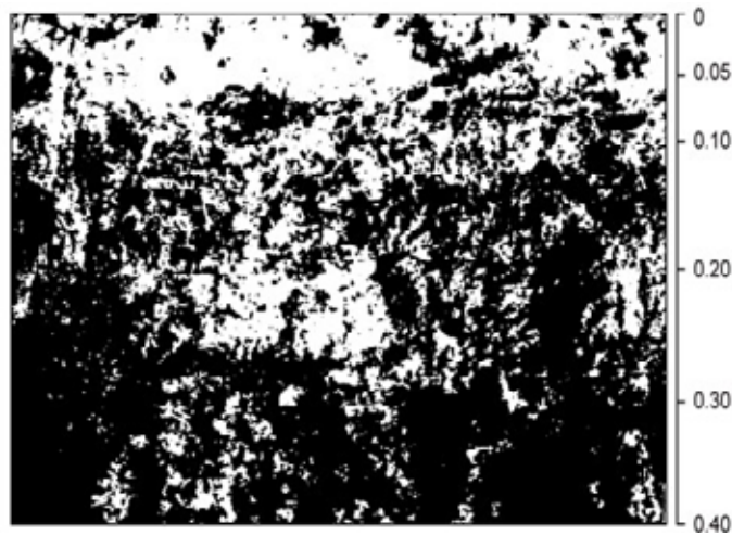
Obr. 420: Penetrační odpor napříč půdním profilem vůči směru jízdy. Patrné jsou dopady přejezdu po pozemku vyjádřené změnou hodnot penetračního odporu (zdroj Kroulík).
