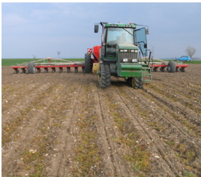
Obr. 188: Při setí do vrcholu hrůbku je potřebné zajistit přesné navedení stroje na hrůbek a udržení trajektorií výsevních sekcí na vrcholu hrůbku (foto Kroulík).
