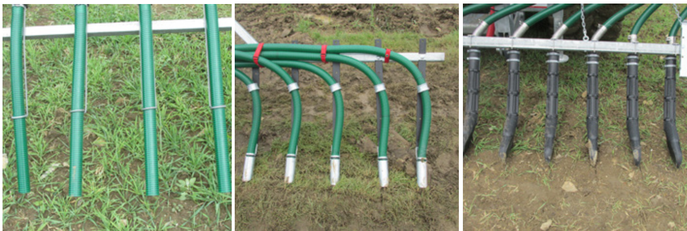
Obr. 347: Rozdílné způsoby zakončení hadicových aplikátorů pro povrchovou aplikaci tekutých hnojiv (foto Brant).
