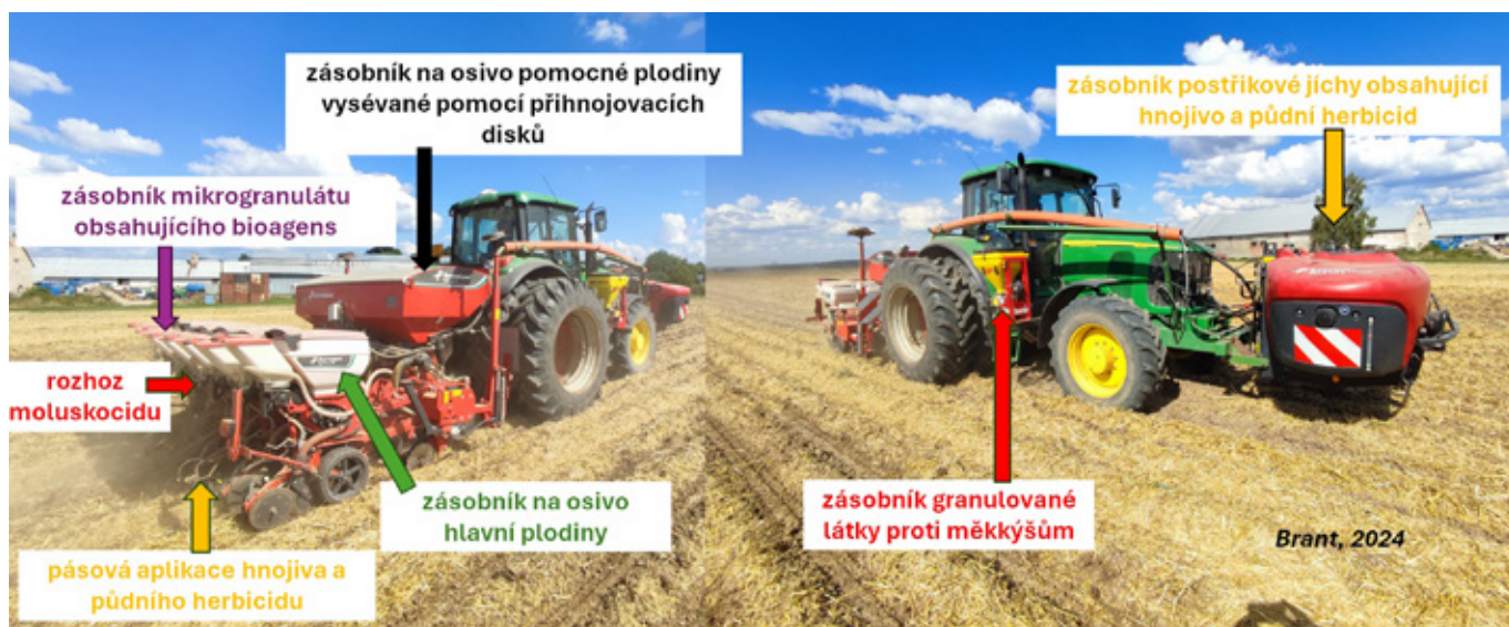
Obr. 246: Modifikovaná pracovní souprava pro přesný výsev ozimé řepky se souběžnou pásovou aplikací hnojiva a půdního herbicidu na pás kypřené půdy po provedení strip till, s aplikací mikrogranulátu obsahujícího fytoosanitárně působící houby do řádku vysévané plodiny, se souběžným výsevem pomocné plodiny pomocí přihnojovacích disků ze zásobníku umístěného na stroji a s plošnou aplikací moluskocidu z univerzálního rozmetadla (foto a zpracování Brant).
