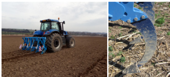
Obr. 98: Kypřiče pro hloubkové kypření jsou rovněž vybavovány pojistnými systémy eliminujícími poškození pracovních nástrojů (foto Brant).
