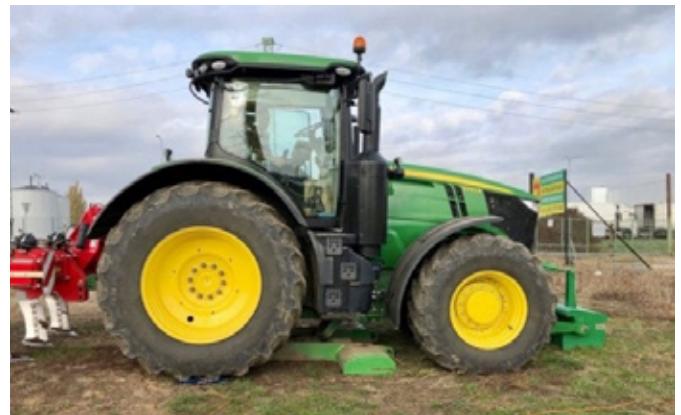
Obr. 439: Možnost dotěžování traktoru pomocí rychloupínacího závaží (foto Pinkas).
