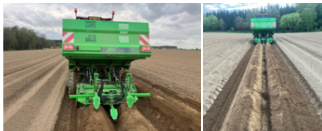
Obr. 362: Široké uplatnění v protierozní ochraně půdy mají systémy hrázkování, kdy jsou v prostoru mezi hrůbkami, či v prostoru mezi hrůbkami a na vrcholu hrůbků, vytvářeny speciálními hrázkovači umístěnými na sazečích brambor prohlubně zakončené hrázkou, které omezují soustředný odtok vody (foto Holejšovský).
