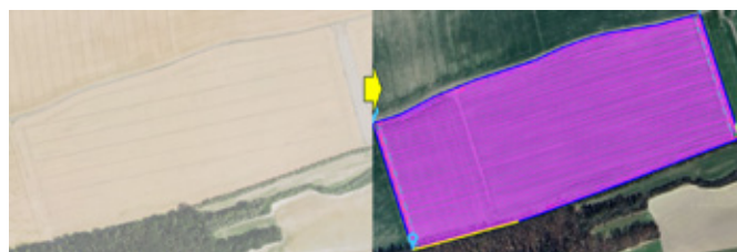
Obr. 378: Návrh trajektorií pohybu testované pracovní soupravy o pracovním záběru 3 m managerem pohybu (foto Vitek).
