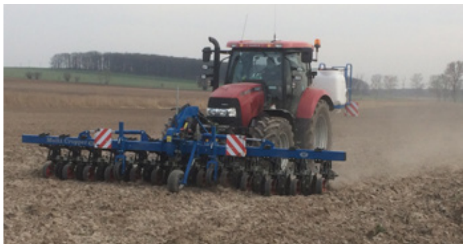
Obr. 412: Kombinace kultivátoru pro zonální předsetovou přípravu s aplikací kapalných hnojiv (foto Kroulík).
