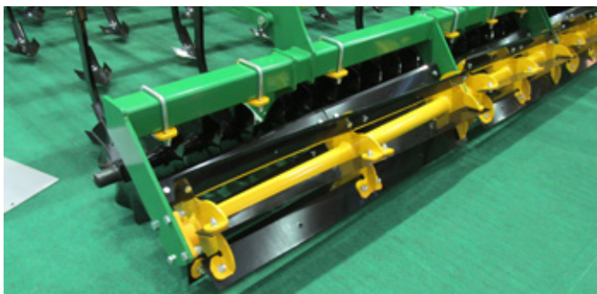
Obr. 264: Řezné válce mohou být součástí dalších strojů, například pro zpracování půdy (foto Brant).
