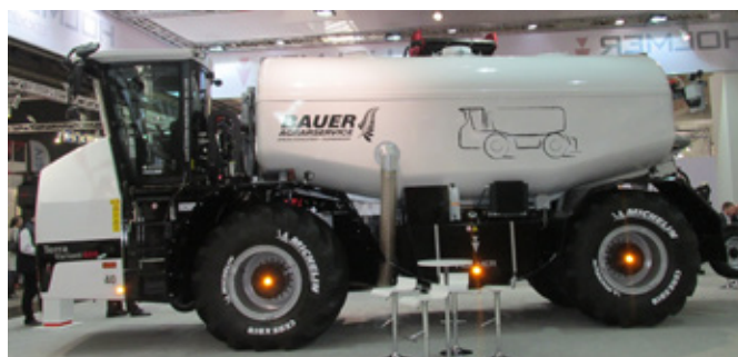
Obr. 336: Snižování tlaku v pneumatikách a využití krabího chodu je jednou z možností snížení utužení půdy (foto Brant).
