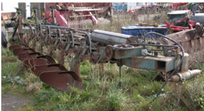
Obr. 68: Jednostranné pluhy umožňují pouze záhonový způsob orby (foto Brant).
