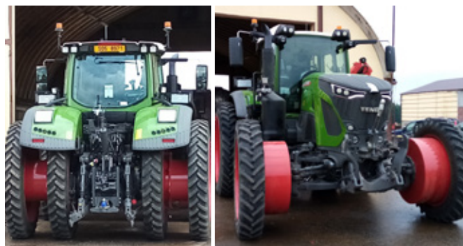
Obř. 106: I při provedení předseťové přípravy pro plodiny vysévané do širokých řádků lze použít optimalizaci rozchodu kol tak, aby kolejev stopy nacházely v budoucím meziřádku vyseté plodiny. Základem je samozřejmě optimalizace tlaku v pneumatikách (foto Brant).
