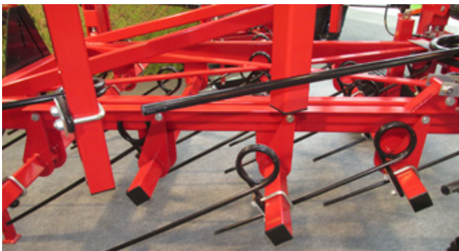
Obr. 127: Mulčovací brány zajistí rovnoměrné rozložení slámy na pozemku (foto Brant).
