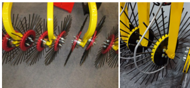
Obr. 290: Kolové brány s pružnými pruty se vyznačují menší agresivitou ve vztahu k pronikání do půdy a navýšení efektu pokrytí povrchu půdy je řešeno šikmým postavením kol ve směru pracovní jízdy (foto Brant).
