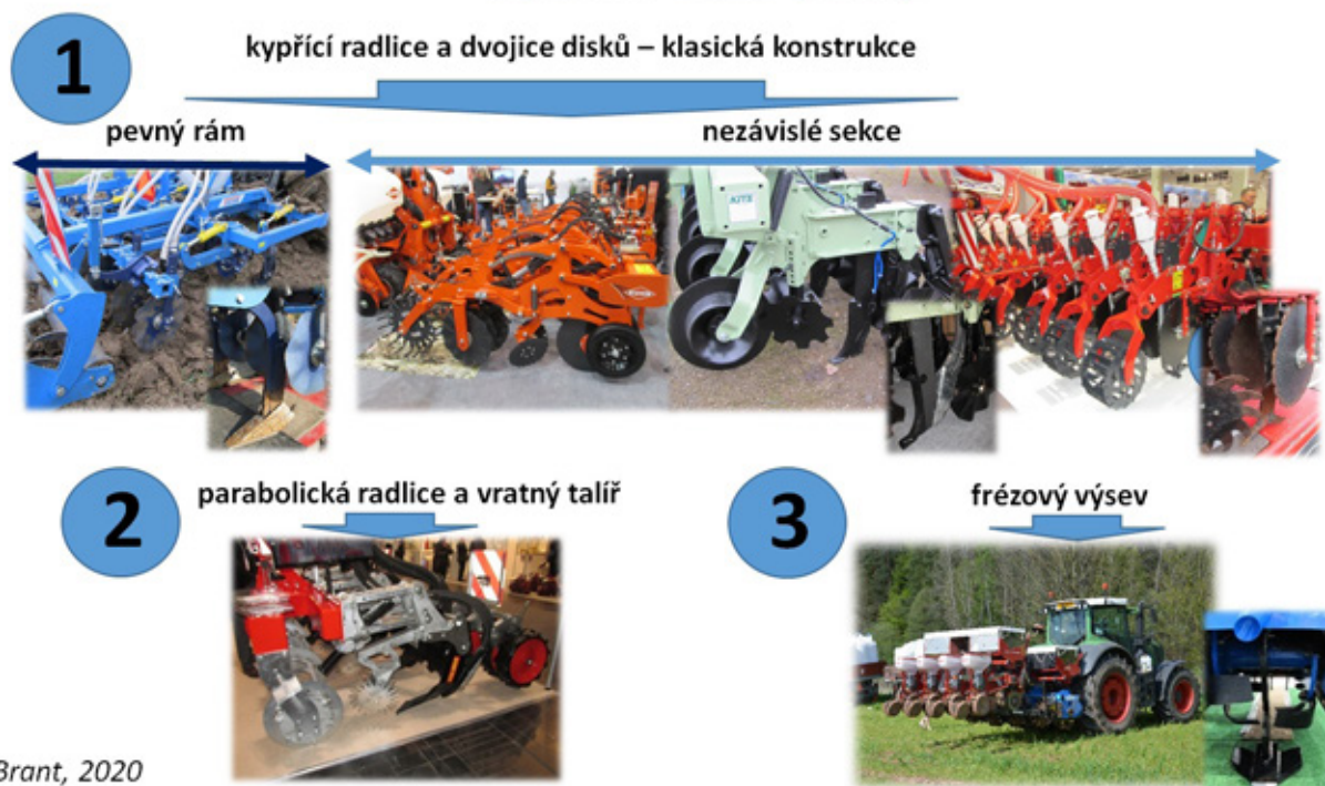
Obr. 197: Pro pásové zpracování půdy ke kukuřiči seté lze dnes využít rozdílná technická řešení umožňující pásové zpracování půdy.
