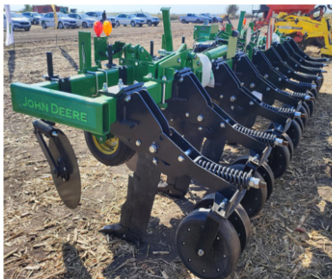
Obr. 40: U některých konstrukcí se před jednotlivými kypřičími radlicemi nacházejí řezné kotouče a zpětné zatlačení půdy kolem nakypřené rýhy po průjezdu radlice zajišťují zamačkávací kola (foto Brant).
