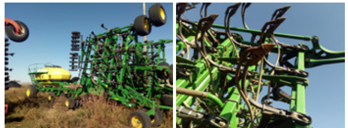
Obr. 223: Secí stroje s výsevem za radličku dlátovitého tvaru, Kazachstán (foto Brant).
