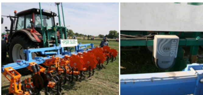
Obr. 320: Ultrazvukový senzor určený pro přesné vedení pracovních sekcí v meziřádku (foto Kroulík).
