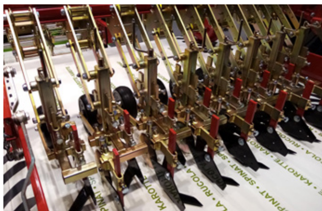
Obr. 295: V polních plodinách vysetých do řádků s malou roztečí lze případně využít rozdílné systémy pracovních nástrojů určených pro práci v porostech zelenin (foto Brant).
