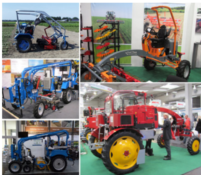
Obr. 318: Konstrukce speciálních nosičů umožňují čelní zavěšení nářadí nebo jeho umístění mezi přední a zadní kola nosiče (foto Brant).
