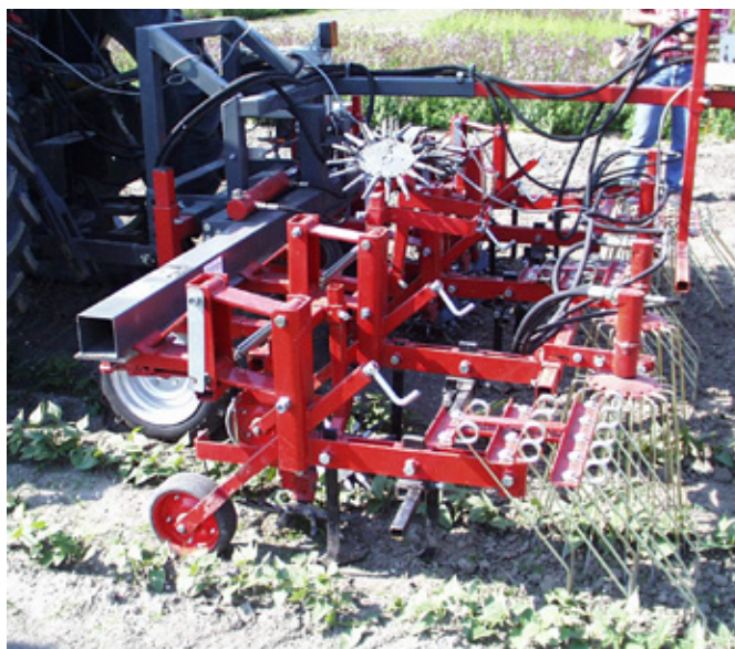
Obr. 291: Systémy s rotujícími pružnými pruty s vertikální osou rotace (foto Brant).
