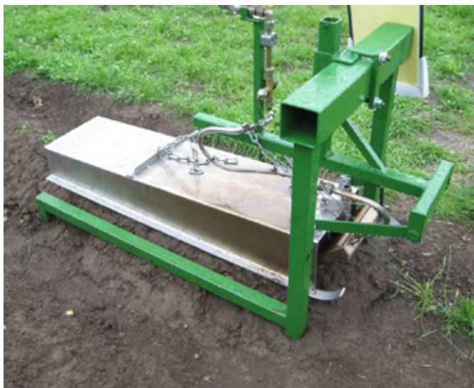
Obr. 313: Pro preemergentní regulaci plevelů z vrcholu hrůbku lze použít modifikované termické plečky (foto Brant).
