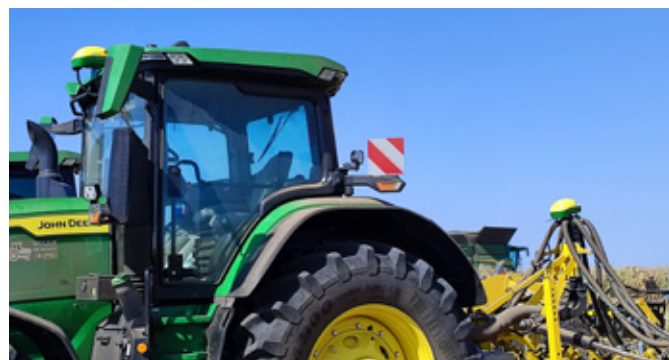
Obr. 326: Systém aktivního navádění stroje do požadovaných jízdni stop při práci na svazích pomocí najíždění soupravy proti svahu s doplněním druhé navigace na stroj (foto Brant).
