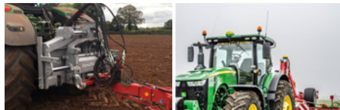
Obr. 393: Systém aktivního navádění stroje do požadovaných jízdních stop při práci na svazích pomocí posuvného závěsu nebo doplněním druhé navigace na stroj a řízením traktoru (zdroj Strom Praha, a.s.).
