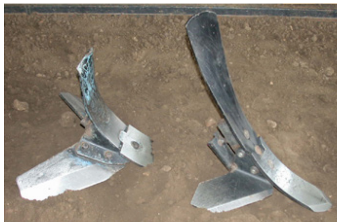
Obr. 17: Radličky se zvýšeným mísicím efektem (vlevo) a radličky zajišťující zejména nakypření půdy bez výraznějšího efektu mísení či obracení půdy - vpravo (foto Brant).
