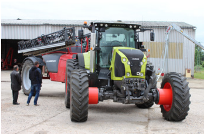
Obr. 406: Rozšíření rozchodu kol s použitím speciálních náprava a koncových převodů (foto Kroulík).
