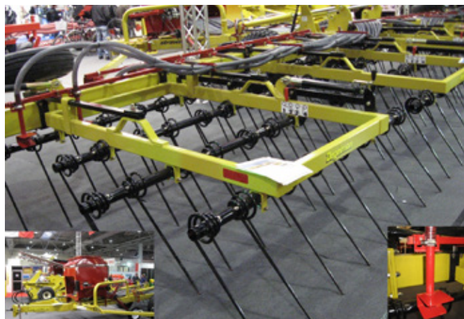
Obr. 11: Při založení porostů meziplodin přímo do strniště lze provést výsev pomocí rozptylových deflektorů umístěných na rámu mulčovacích bran (foto Brant).
