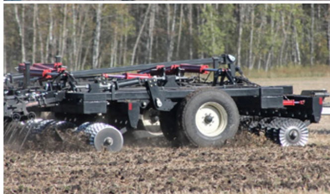
Obr. 164: Stroje pro velmi mělké zpracování půdy pro následný výsev plodin (foto Gates Manufacturing, https://www.gatesmfg.net/ ).
