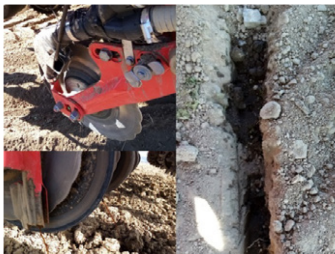
Obr. 250: Vyvedení aplikačních hadiček k přihnojovacím diskům secího stroje (vlevo) a následný rozptyl kapaliny v místě aplikace (vpravo), foto Brant.
