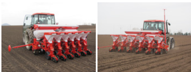
Obr. 177: Secí stroj pro přesné setí plodin do širokých řádků s variabilní roztečí výsevních sekcí. Změna rozteče se provádí automaticky z kabiny traktoru. Vlevo je rozteč sekcí 0,45 m a vpravo 0,75 m (foto Brant).
