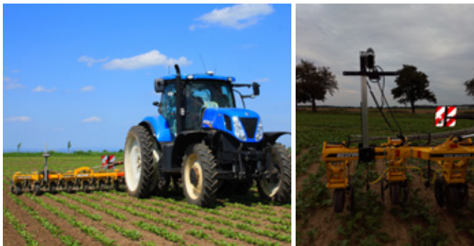
Obr. 319: Kamerový systém pro zajištění přesné navigace kultivátoru v meziřadí (foto Kroulík).
