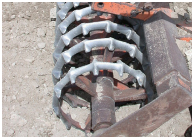
Obr. 130: Crosskillské válce tvoří shodně velké kotouče s bočními zuby (foto Brant).
