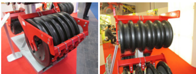
Obr. 137: Systémy pýchovacích válců s menšími prohlubněmi mezi prstenci více rozkládají hmotnost válce na celý povrch půdy (foto Brant).
