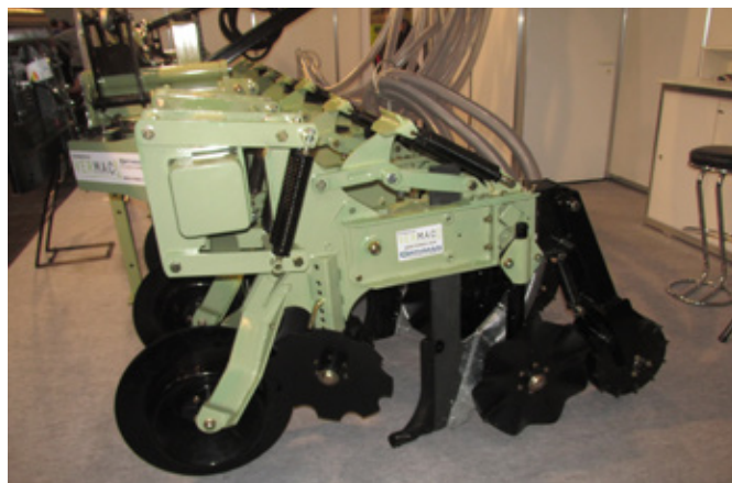
Obr. 356: Většina strojů pro aplikaci tekutých hnojiv vychází z koncepce aplikace hnojiva za kypřicí radlici (foto Brant).
