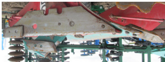
Obr. 91: Podrýváky mohou být umístěny za každým orebním tělesem nebo pouze před prvním orebním tělesem (foto Brant).
