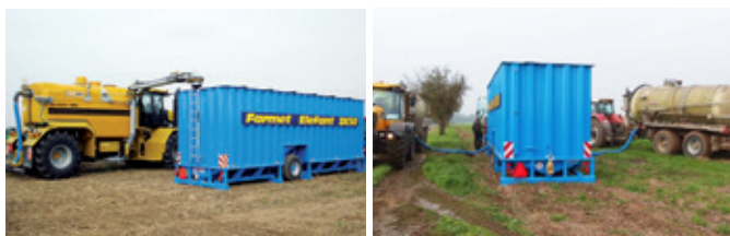
Obr. 344: Mezizásobníky tekutých hnojiv zvyšují nejen výkonost pracovních linek, ale mohou přispět ke snížení počtu nepracovních jízd po pozemku (foto Farmet a.s., https://www.farmet.cz/ ).
