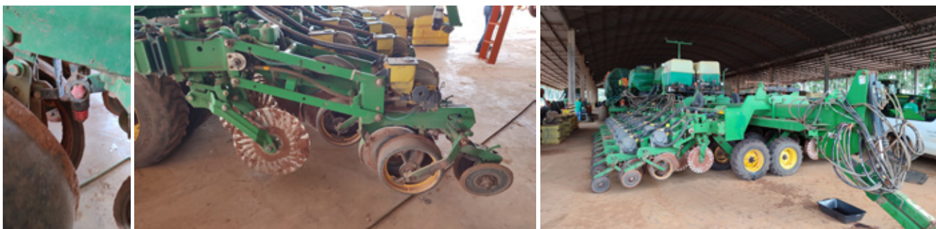
Obr. 251: Aplikaci bioagens lze provést i při výsevu do nezpracované půdy, kdy je jícha aplikována postřikem na výsevní rýhu před jejím uzavřením zamačkávacími kotouči, Brazílie (foto Brant).
