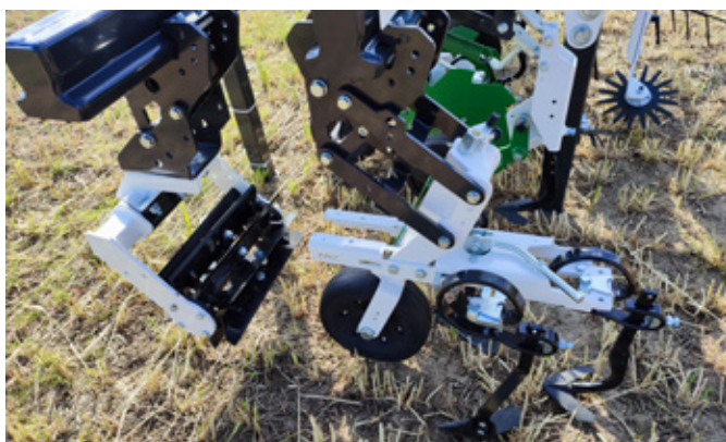
Obr. 317: Řezné válce pro umrtvení porostů v meziřádku plodin s velkou roztečí řádků (foto Brant).
