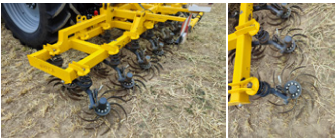
Obr. 28: Konstrukce využívající principů mělkého odříznutí rostlinných zbytků či plevelů (foto Brant).
