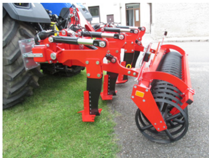
Obr. 99: Pro hloubkové kypření mohou být pracovní nástroje osazeny i postranními křídly, jejichž úkolem je pouhé nadzvednutí půdy, která při zpětném pohybu ve směru gravitace praská (foto Brant).
