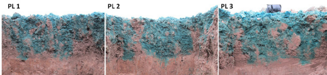
Obr. 86: Simulace infiltrace vody do půdy metodou modré infiltrace na plochách při hodnocení tří rozdílných pluhů (11.12.2014) PL 1 až PL 3 (foto Brant).
