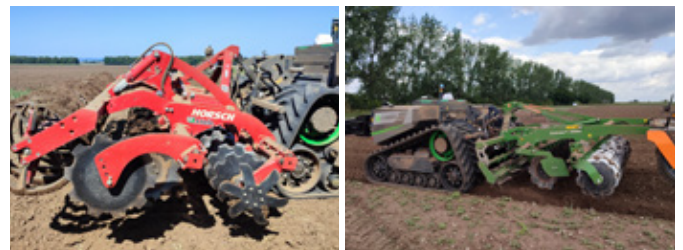
Obr. 20: Talířové kypřiče menších záběrů jsou velmi často agregovány s autonomními robotickými platformami s výkonem motoru do 115 kW (foto Brant).
