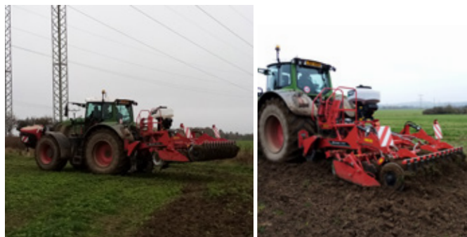
Obr. 44: Tyto konstrukce umožňují jak prokypření spodních vrstev ornice, tak dobré prokypření horní vrstvy orničního profilu (foto Brant).
