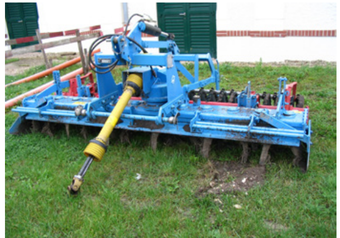
Obr. 35: Rotační kypřiče lze využít pro zpracování půdy do hloubky 0,15 m (foto Brant).
