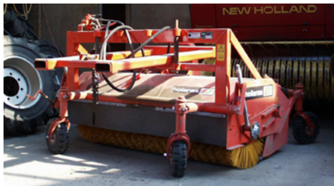
Obr. 276: Kartáčové plečky pracují na principu rotujícího kartáče s dlouhými pružnými umělohmotnými vlákny, mezi která se zachytávají nadzemní části plevelů a v důsledku rotace kartáče jsou z půdy vytrženy i s kořenovým systémem (foto Brant).
