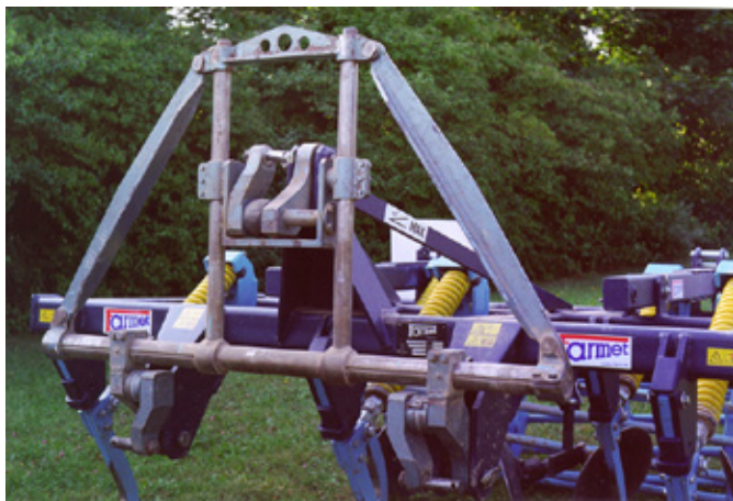
Obr. 423: Měřicí rám vkládaný mezi traktor a měřený stroj (foto Kroulík).
