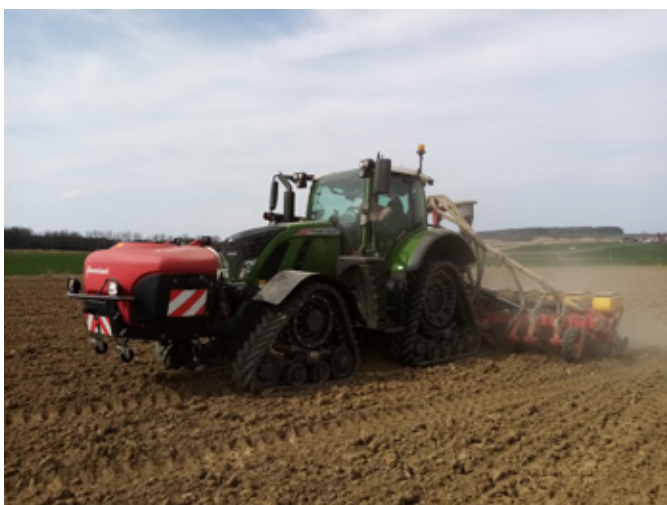
Obr. 249: Secí souprava přesného secího stroje a čelně nesené nádrže na kapalnou jíchu při výsevu porostů sóji s aplikací symbiotických bakterií k řádku osiva (foto Brant).
