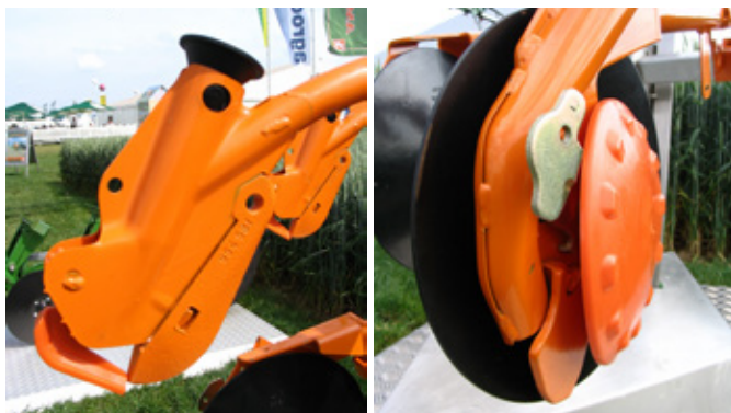
Obr. 110: Klasické radličkové (vlevo) a vpravo jednokotoučové výsevní botky jsou vhodné především pro kvalitně celoplošně zpracovanou půdu (foto Brant).
