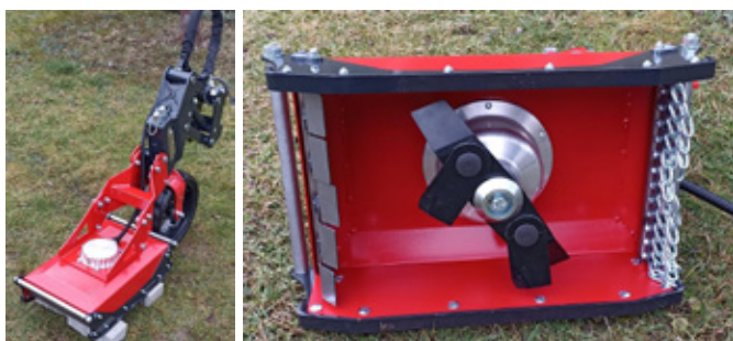
Obr. 316: Prototyp meziřádkového mulčovače vyvinutého Centrem precizního zemědělství s využitím elektropohonu rotoru (foto Kroulík).
