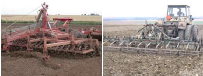
Obr. 142: Kypřiče s pružnými slupicemi a dlátovými radličkami lze při optimální půdní vlhkosti použít na těžších půdách i pro předsetovou přípravu k ozimým obilninám po sklizni okopanin (foto Brant).
