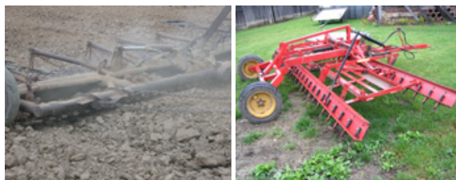
Obr. 124: Přední, někdy zadní, smyková deska je opatřena zuby či hřebí, většina smyků je rovněž vybavena systémem pro nastavení úhlu smykových desek vůči povrchu půdy (foto Brant).
