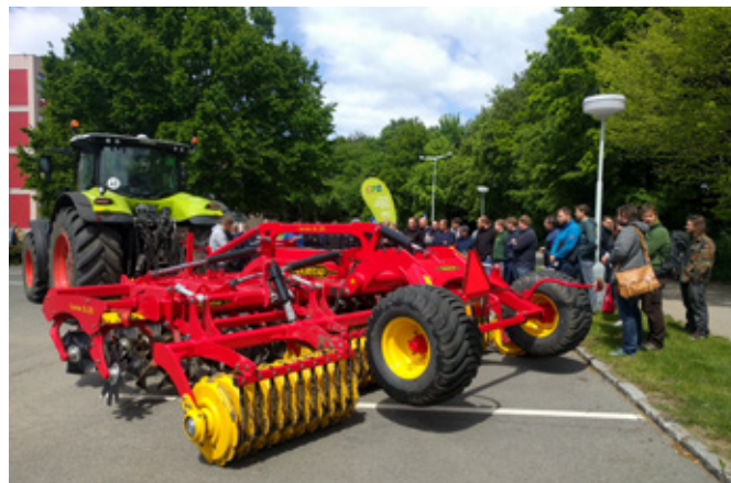
Obr. 25: U strojů pro velmi mělké kypření se lze v rámci technických řešení setkat se systémy s výrazně zvlněnými řeznými talíři (foto Brant).
