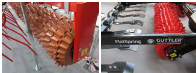
Obr. 128: Hrudořezné válce dobře drtí suché a tvrdé hroudy (foto Brant).
