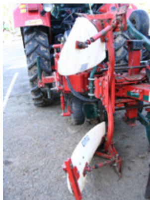
Obr. 65: Využití plastových odhrnovaček má usnadnit posun skývy po odhrnovačce, včetně snížení přilnavosti půdních částic (foto Brant).
