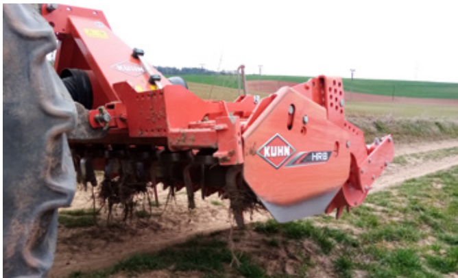
Obr. 146: Rotační brány jsou vhodné pro zpracování hrubé brázdy a přípravu půdy po setí následující po mělkém zpracování půdy (foto Brant).
