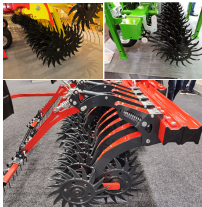
Obr. 286: Hvězdicové kotouče zajišťují vytržení plevelu z kypřené půdy na základě jeho podkopnutí a odhození pracovním nástrojem (foto Brant).
