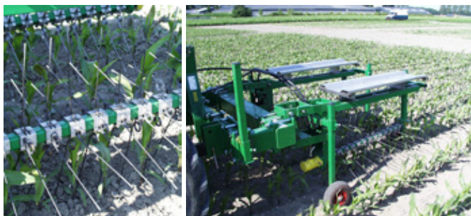
Obr. 312: Meziřádková regulace plevelů na základě ve šroubovici umístěných a otáčejících se pružných prutů (foto Brant).
