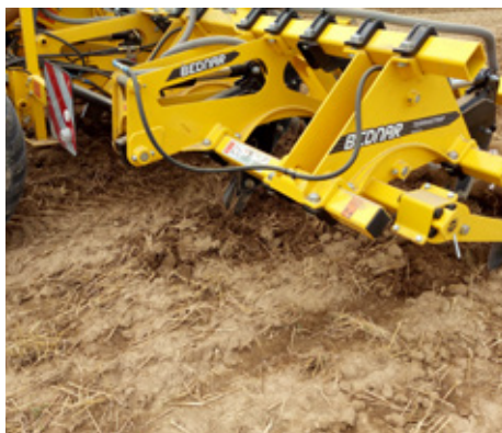
Obr. 45: Stroje pro hlubší diferencované zonální kypření zajišťují hlubší prokypření půdy v místě budoucího řádku rostlin a zároveň i intenzivnější mělké kypření horní vrstvy půdy i mezi hlouběji pracujícími radlicemi (foto Brant).
