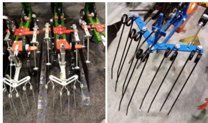
Obr. 293: Příklady modifikace prutových bran a jejich osazení na rámy pleček (foto Brant).
