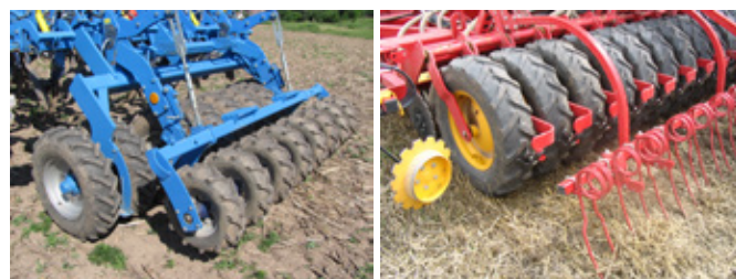
Obr. 134: Klasické pneumatikové pěchy nacházejí své uplatnění na strojích pro základní zpracování půdy a pro předseťovou přípravu, ale zásadní význam mají na secích strojích (foto Brant).
