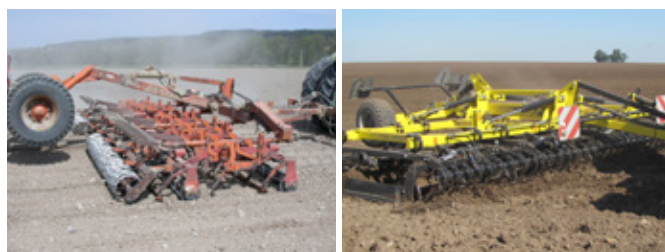
Obr. 140: Radličkové kypřiče se šípovitými radličkami se využívají pro předsetovou přípravu k cukrové řepě, ale i k ostatním polním plodinám (foto Brant).
