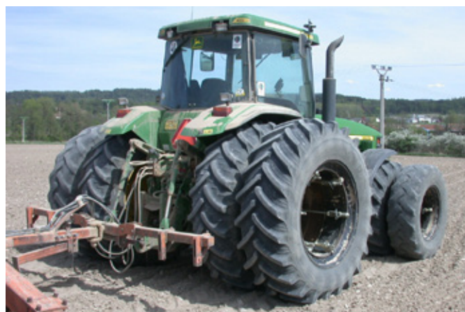
Obr. 102: Zdvojená kola traktoru snižují měrný tlak na půdu (foto Brant).
