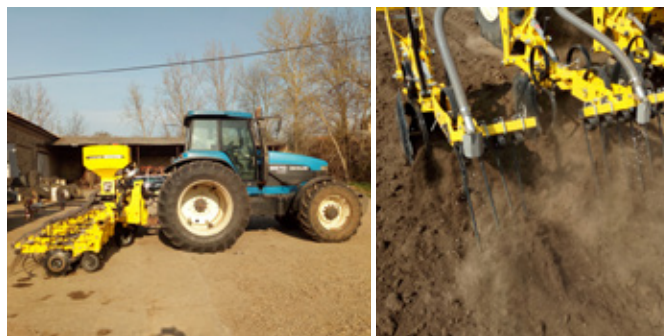
Obr. 158: Konvenční plečka upravená pro pásovou předsetovou přípravu pro cukrovou řepu osazená zásobníkem a systémem rozvodu hnojiva za kypřící sekce (vlevo) a zachycení aplikace hnojiva s využitím usměrňovacích deflektorů (foto Brant).
