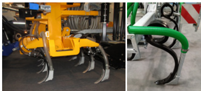
Obr. 354: Mělké či hlubší zapravení do půdy pomocí aplikačních dlát (foto Brant).
