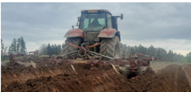
Obr. 364: Pomocí rýhovače vytvářejícího hrůbky jsou připraveny záhony pro následnou separaci půdy (foto Holejšovský).
