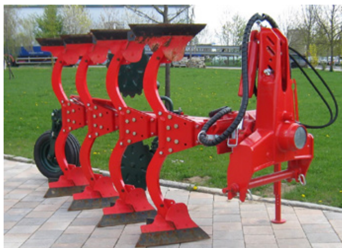
Obr. 33: Omezení obraccího efektu odhrnovačky zvyšuje regulaci vytrvalých plevelů především v systémech ekologického zemědělství (zdroj: https://zobel-stahlbau.de ).
