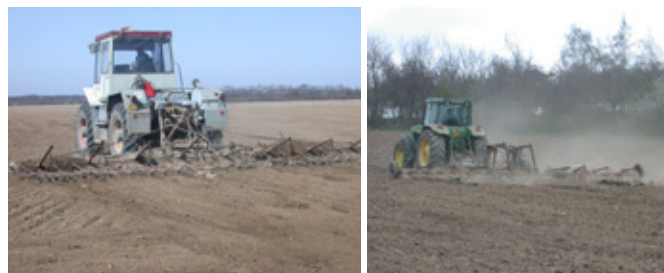
Obr. 122: Klasická předsetová příprava půdy se provádí pomocí kombinátorů složených ze smyků a hřbových bran (foto Brant).
