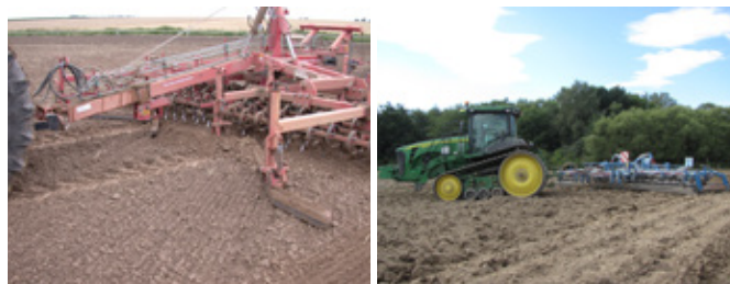
Obr. 123: Smykové desky jsou rovněž součástí kombinovaných strojů pro předsetovou přípravu půdy (foto Brant).
