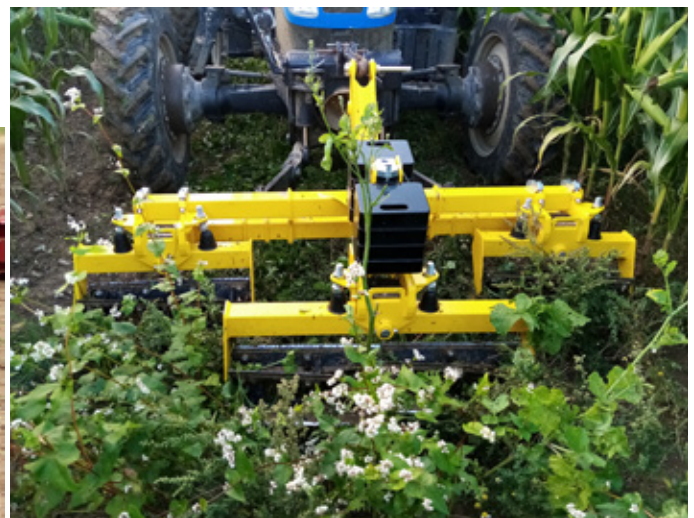
Obr. 269: Pro technologii ozeleněných trajektorií je vhodnější použít řezné válce se možností změny záběru, které lze dobře přizpůsobit požadovaným podmínkám zemědělského subjektu (foto Brant).
