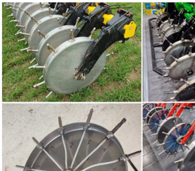
Obr. 331: Aplikáčnı kola lze osadit rozdílnými typy injektážnıch jehel (foto Brant).
