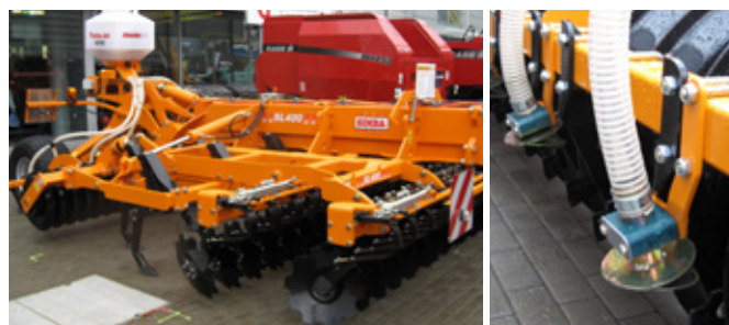
Obr. 9: Umístění secího stroje s válečkovým výsevním ústrojím a s následným pneumatickým transportem osiva na kombinovaném kypřiči (foto Brant).
