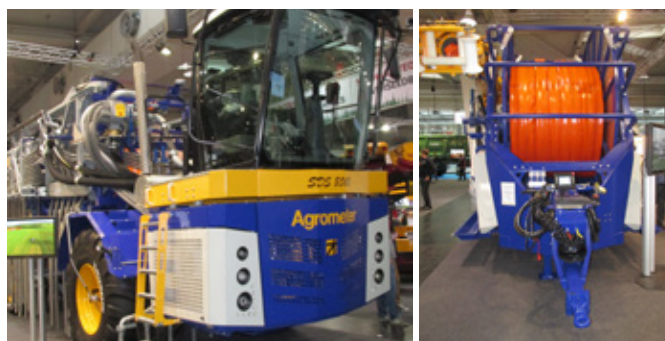
Obr. 338: Systémy vlečných transportních hadic lze využít u samojízdných, tak tažených strojů (foto Brant).
