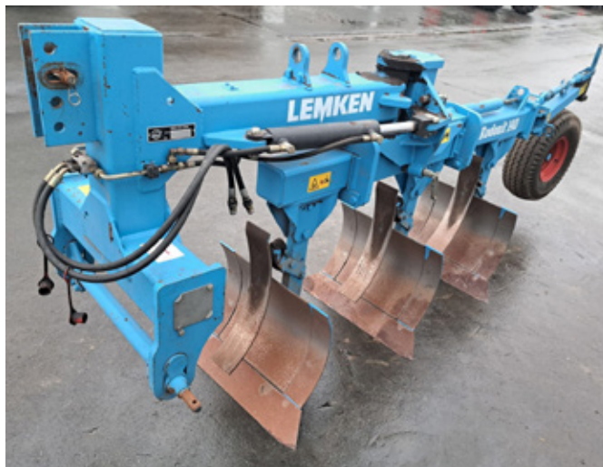
Obr. 70: Oboustranný výkyvný pluh je vhodný pro orbu lehkých půd (foto AGRAVIS Raiffeisen AG, https://www.agravis.de/ ).
