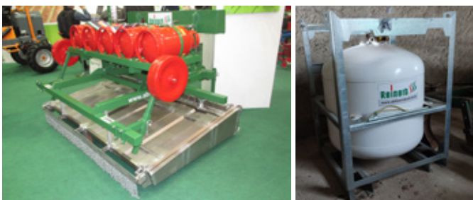
Obr. 278: V současné době jsou na trhu dostupná moderní konstrukční řešení a velmi často jsou soupravy vybaveny čelně neseným zásobníkem na plyn (foto Brant).
