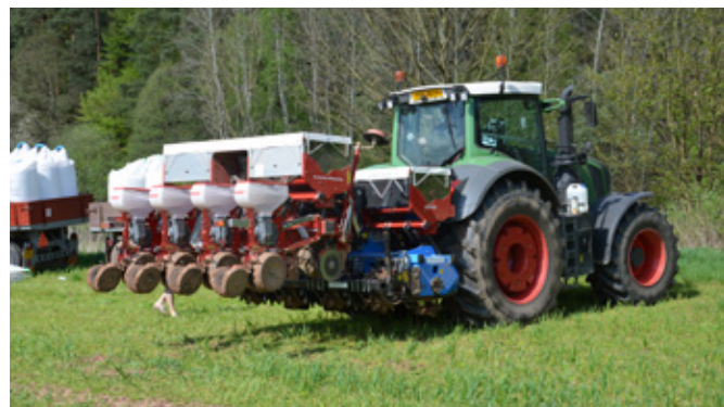
Obr. 207: Souprava pro souběžné zpracování půdy, zonální hnojení a výsev hlavní plodiny (foto Hovad).
