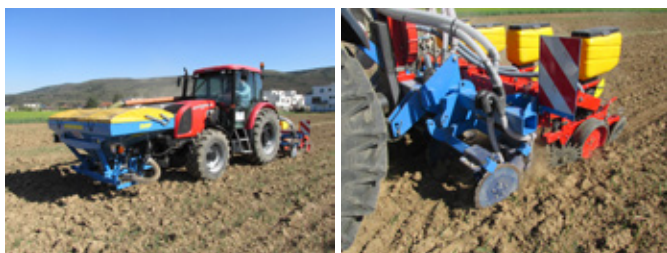
Obr. 160: Dostupné jsou i konstrukce, kde jsou pracovní nástroje pro provedení pásové předseťové přípravy umístěny přímo na secím stroji, v tomto případě se jedná o dvojici výškově stavitelných kotoučů, včetně systému aplikace hnojiva ke kotoučům z čelního zásobníku traktoru (foto Brant).
