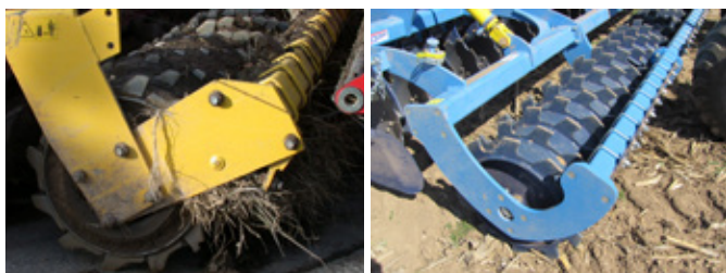
Obr. 132: Ozubené utužovací válce na secích kombináčích (vlevo) utužují půdu v místě uložení osiva, při použití na strojích pro zpracování půdy a pro předseťovou přípravu mají za cíl utužení půdy, urovnání povrchu pozemku a rozdrobení hrud (foto Brant).
