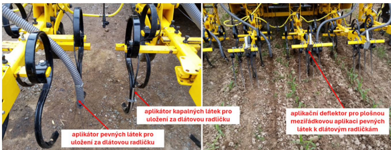
Obr. 301: Pro plečkování lze rovněž využít radličky zakončené dlátý, která jsou umístěná na pružných slupicích (foto a zpracování Brant).
