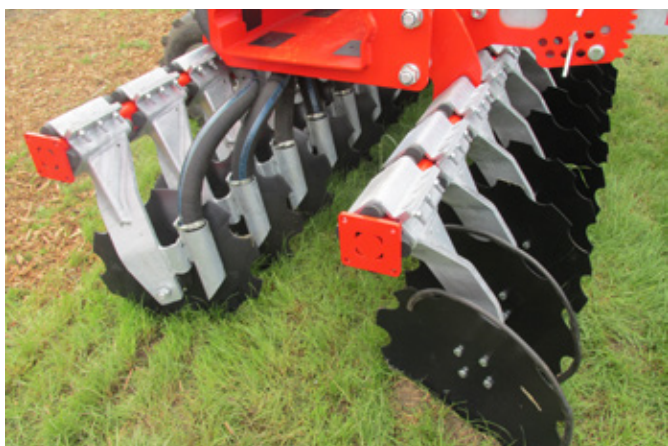
Obr. 353: Souběžné celoplošné mělké zapravení do půdy s hadicovým transportem ke kypřicím talířům (foto Brant).
