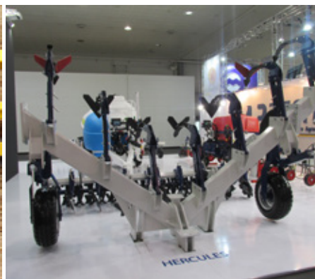
Obr. 45: Stroje pro hlubší diferencované zonální kypření zajišťují hlubší prokypření půdy v místě budoucího řádku rostlin a zároveň i intenzivnější mělké kypření horní vrstvy půdy i mezi hlouběji pracujícími radlicemi (foto Brant).
