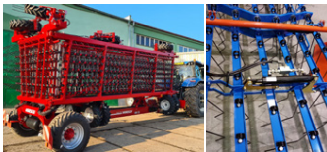
Obr. 282: Moderní konstrukce prutových bran zajišťují centrální nastavení přítlaku na jednotlivé pruty z kabiny traktoru (foto Brant).
