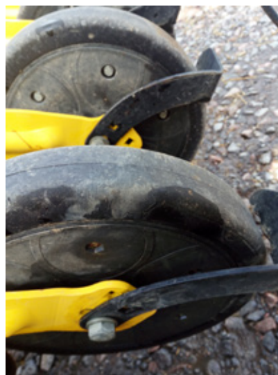
Obr. 112: Hloubka setí je spojena i s možností změny přítlaku na secí botku, kterou lze u moderních secích strojů pro plodiny s malou roztečí řádků nastavovat individuálně pro každou botku (foto Brant).
