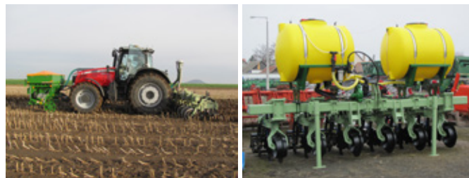
Obr. 201: Provedení pásového kypření s aplikací granulovaných minerálních hnojiv do kypřeného pásu (vlevo), vpravo se nachází stroj pro pásové zpracování půdy se zásobníky na kapalná hnojiva (foto Brant).
