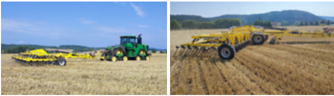
Obr. 26: Systémy kombinující řezné talíře a kypřicí pruty lze využít i pro rovnoměrné rozvrstvení slámy na pozemku (foto Brant).
