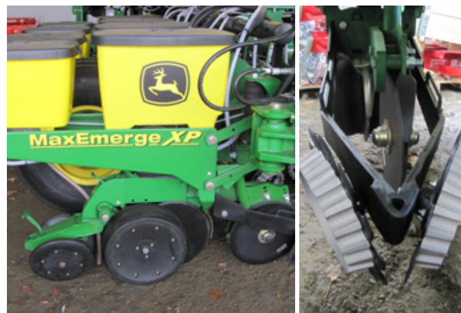
Obr. 118: Stroje pro přesné setí určené pro výsev do nezpracované půdy či do půdy s přítomností živého nebo mrtvého mulče meziplodiny mohou být vybaveny dvojicí řezných kotoučů (foto Brant).
