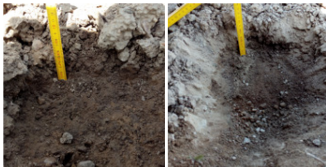
Obr. 148: Vliv rozdílných kypřicích nástrojů na profil kypřeného pásu, vlevo radlička s roztečí 220 mm, vpravo se záběrem 150 mm (foto Brant).
