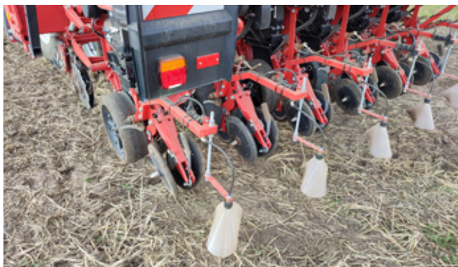
Obr. 247: Při pásové aplikaci látek na řádek vyseté plodiny lze samozřejmě využít omezovače úletu aplikované jíchy (foto Brant).
