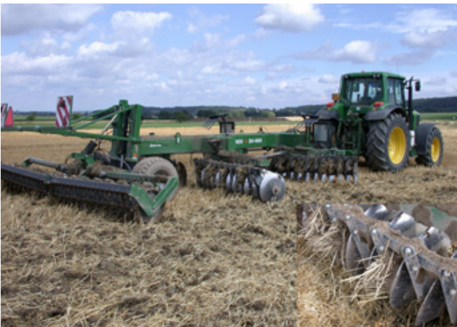
Obr. 18: Talířové kypřiče mohou na povrchu půdy zanechávat velké množství organické hmoty (foto Brant).
