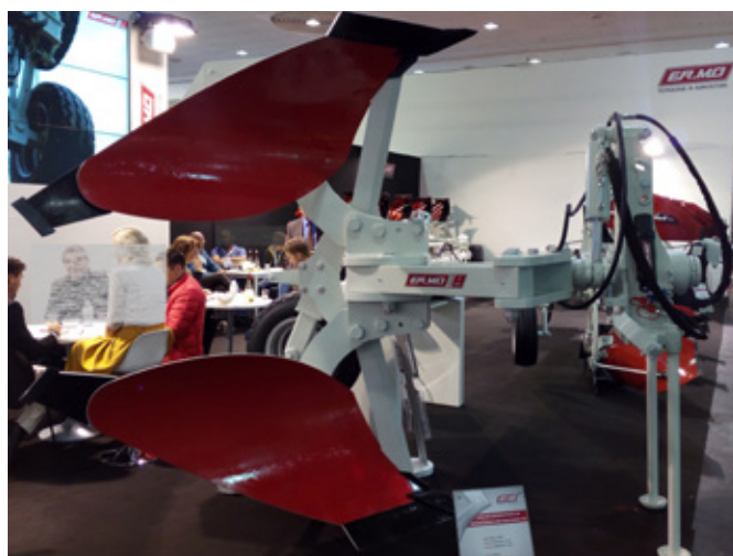
Obr. 74: Rigolovací pluhy jsou určeny k hlubokému zpracování půdy především před zakládáním trvalých kultur (foto Brant).
