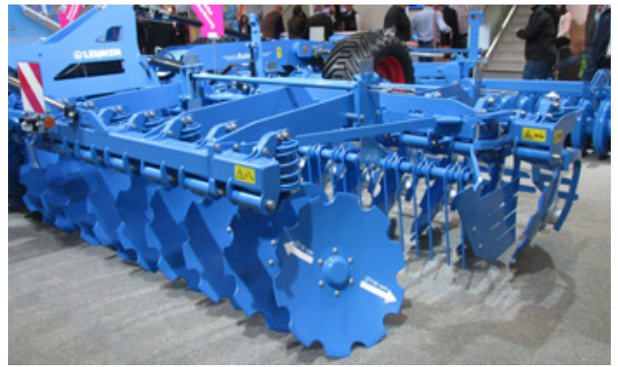
Obr. 19: Pro hlubší zpracování půdy lze využít talířové kypřiče s průměrem pracovních nástrojů 0,7 m a větším (foto Brant).
