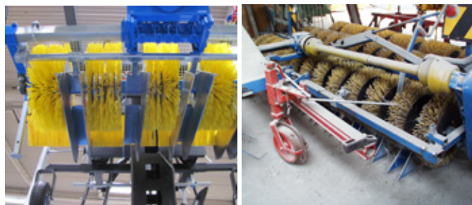
Obr. 306: Kartáčové plečky pro meziřádkovou regulaci plevelů (foto Brant).
