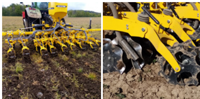
Obr. 162: Systém mělkého pásového zpracování půdy před výsevem sóji do vymrzlé mezipločiny pomocí systému zvlněných talířů, šířka kypřeného pásu je 0,22 m (foto Brant).
