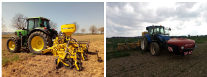
Obr. 237: Souprava pro pásovou předseťovou přípravu umožňující aplikaci minerálních hnojiv do pásu ze zásobníku na pevné látky umístěného na rámu kypřiče (vlevo) a souprava pro souběžnou aplikaci kapalných (čelní zásobník) a pevných látek (zásobník na rámu kypřiče) při pásové předseťové přípravě půdy (vpravo), foto Brant.
