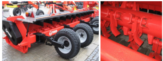
Obr. 261: Mulčovače s horizontální osou rotace pracovních nástrojů (foto Brant).
