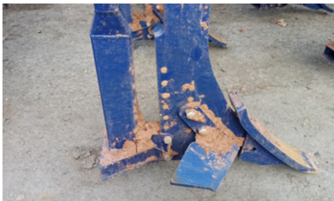
Obr. 359: Kypřicí radlice s aplikátorem kapalných hnojiv s širokou koncovkou rozptylovače se šíří dláta 75 mm pro systém zapravení do proudu zeminy (foto Brant).
