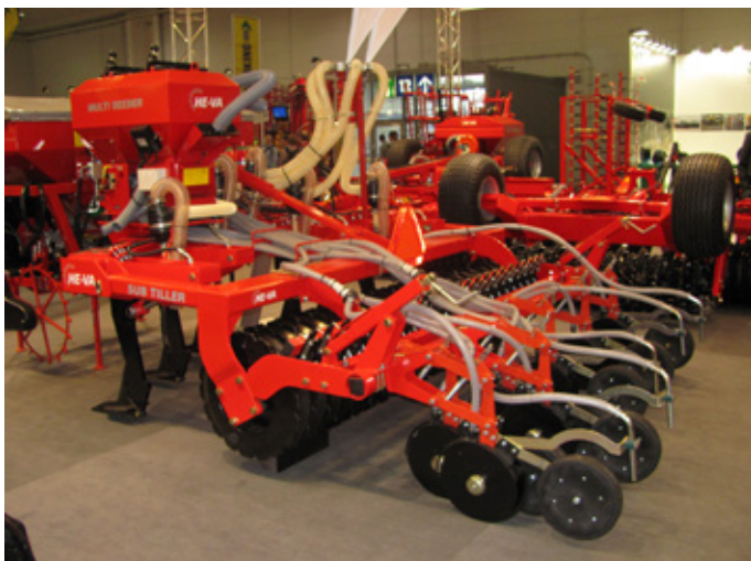
Obr. 231: Stroje jsou vybaveny kypřicími radlicemi, které umožní hlubší prokypření půdy v místě výsevu plodiny (vlevo) a lze je využít i pro založení porostů ozimé řepky do strniště obilní předplodiny (vpravo), foto Brant.
