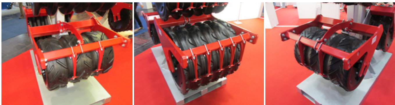
Obr. 133: Značný počet technických řešení umožňujících dosažení rozdílného vlivu na půdu vzniká využitím konstrukcí kombinujících nosný ráfek s gumovým, pneumatice podobným, osazením (foto Brant).
