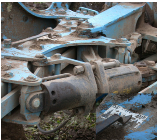
Obr. 58: Díky speciální konstrukci pluhů (tzv. vario-pluh) lze během jízdy plynule měnit záběr pluhu, stupnice na rámu pluhu umožňují traktoristovi nastavit požadovaný záběr (detail) – foto Brant.
