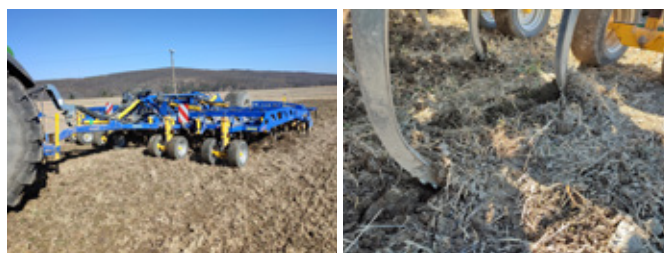
Obr. 24: Systémy velmi mělkého kypření půdy využívající podřezávací radličky umožňují nejen efektivní regulaci plevelů a výdrolu, ale také meziplodin (foto Brant).
