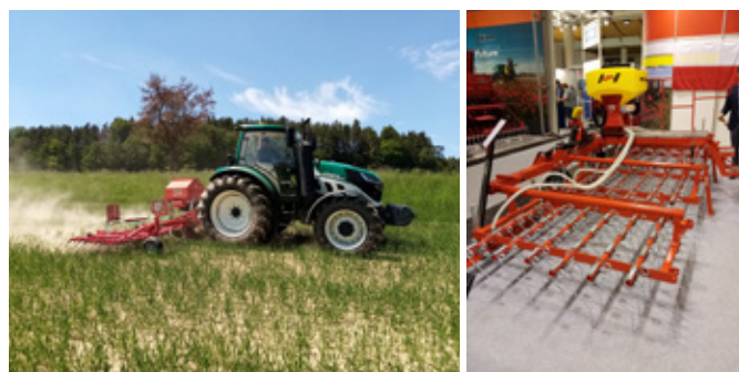
Obr. 280: Prutové brány lze osadit zásobníky osiv pro výsev podsekových mezíplodin či aplikací jiných pevných látek (foto Brant).
