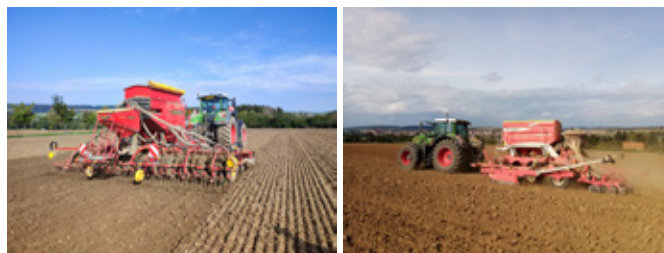
Obr. 170: Pracovní kypřící sekce pro přípravu půdy u secích strojů zajišťují urovnání povrchu půdy, tvorbu seťového lože a vhodné agregátové prostorové uspořádání půdy nad secím ložem (foto Brant).
