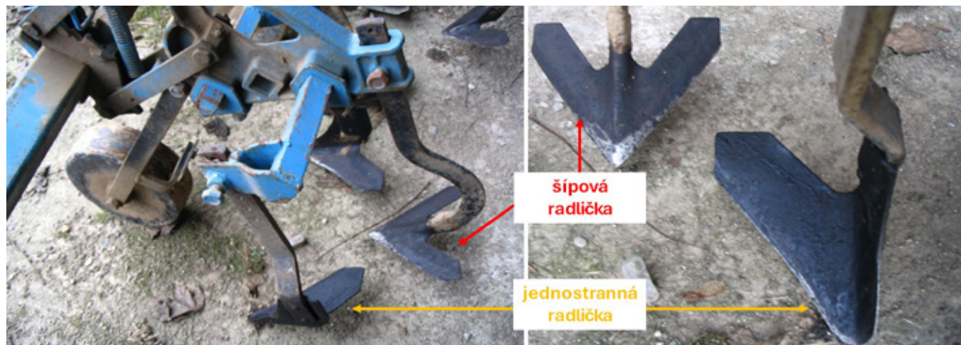
Obr. 296: Jednostranné a šípové radličky zajišťují především podříznutí plevelů (foto a zpracování Brant).
