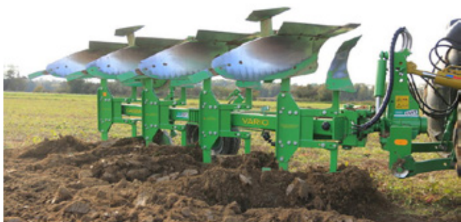
Obr. 97: Do skupiny strojů pro dlátování lze zařadit i pluhy umožňující současné zpracování půdy ve dvou vrstvách (foto GASSNER Technik Landmaschinenbau, https://gassner-technik.de/ ).
