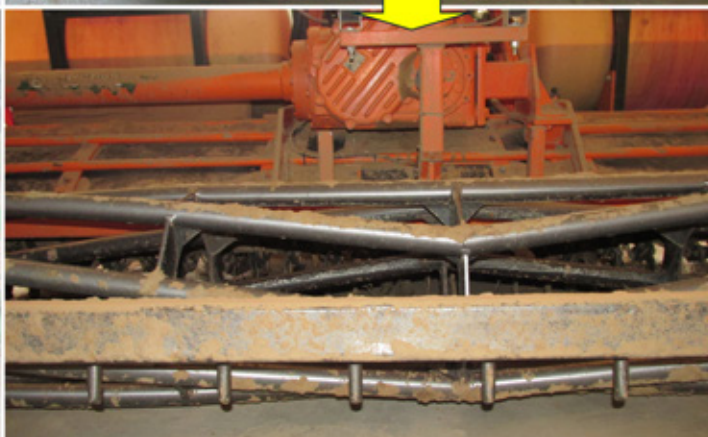
Obr. 367: Souprava pro výsadbu brambor složená ze sazeče brambor a čelně neseného rotačního kypřiče pro souběžné zpracování půdy a sázení (foto Brant).
