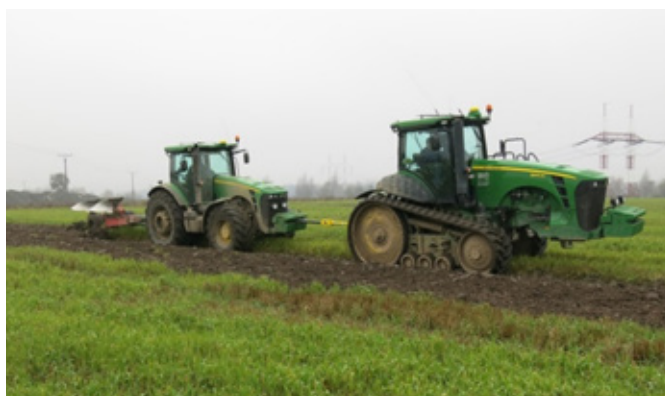
Obr. 425: Měřicí souprava při měření tahové síly během orby (foto Kroulík).
