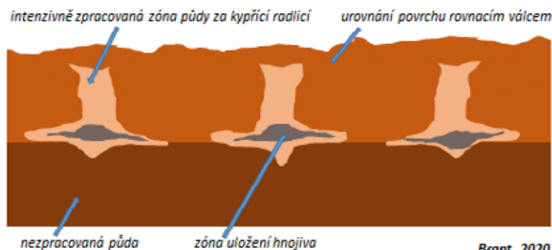
Obr. 358: Princip technologie pro horizontální tvorbu infiltračních zón s využitím aplikace do proudu zeminy.
