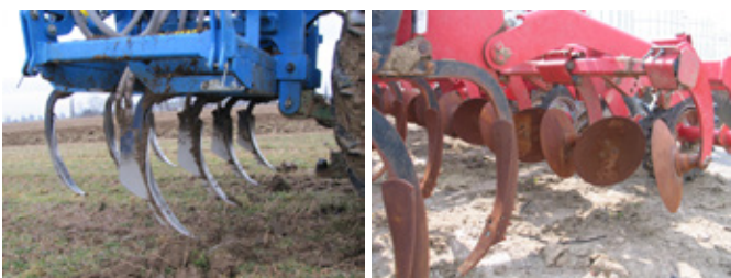
Obr. 180: V Evropě preferovaný systém tvorby hrůbků pomocí systémů kypřících radlic, či radlic a tvarovacích talířů (foto Brant a Kroulík).
