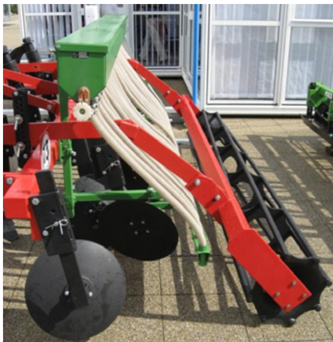
Obr. 7: Secí stroj s válečkovým výsevním ústrojím a s gravitačním transportem osiva umístěný na rámu radličkového kypřiče (foto Brant).
