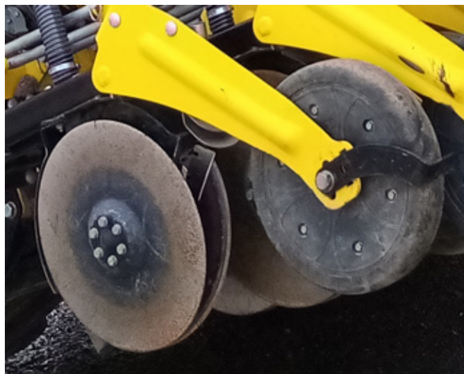
Obr. 111: Secí stroje pro plodiny zakládáné s malou roztečí řádků jsou většinou osazovány dvukotoučovými botkami, které zajistí požadované uložení osiva do půdy i při eliminaci zpracování půdy a při přítomnosti rostlinných zbytků na povrchu půdy (foto Brant).
