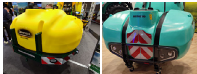
Obr. 238: Komerčně vyráběné čelně nesené zásobníky kapalných látek lze využít pro aplikaci kapalných látek při plošné předseťové přípravě půdy (foto Brant).
