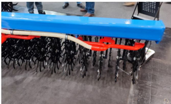
Obr. 289: Při vybavení strojů vhodnými rozvodnými systémy lze aplikovat rozdílné pevné látky při provedení agrotechnického zásahu (foto Brant).
