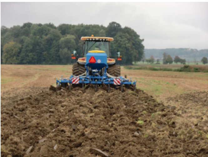
Obr. 181: Stroje pro tvorbu hrůbků lze doplnit o systémy aplikace minerálních hnojiv do středu budoucího hrůbku (foto Brant).
