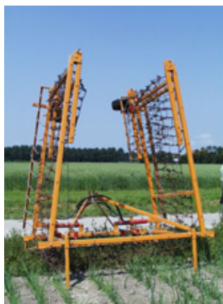
Obr. 285: Sítové brány mají široké uplatnění z hlediska kultivace porostů během vegetace (foto Brant).
