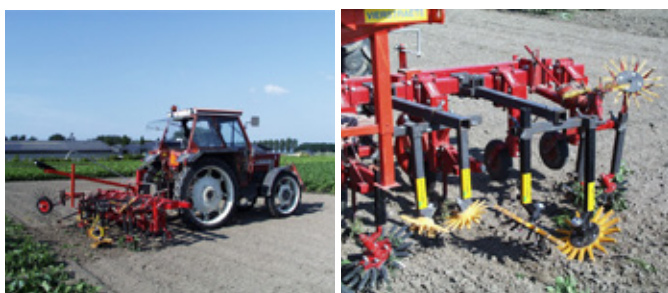
Obr. 308: Rozdílná konstrukce prstových pleček zajišťuje dosažení požadovaného odplevelujícího a kultivačního efektu a omezení poškození kulturních rostlin (foto Brant).
