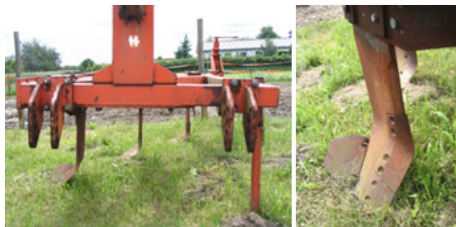
Obr. 41: Zahnuté pracovní nástroje parapluhů kvalitně kypří půdu a zanechávají povrch půdy v přirozeném stavu (foto Brant).
