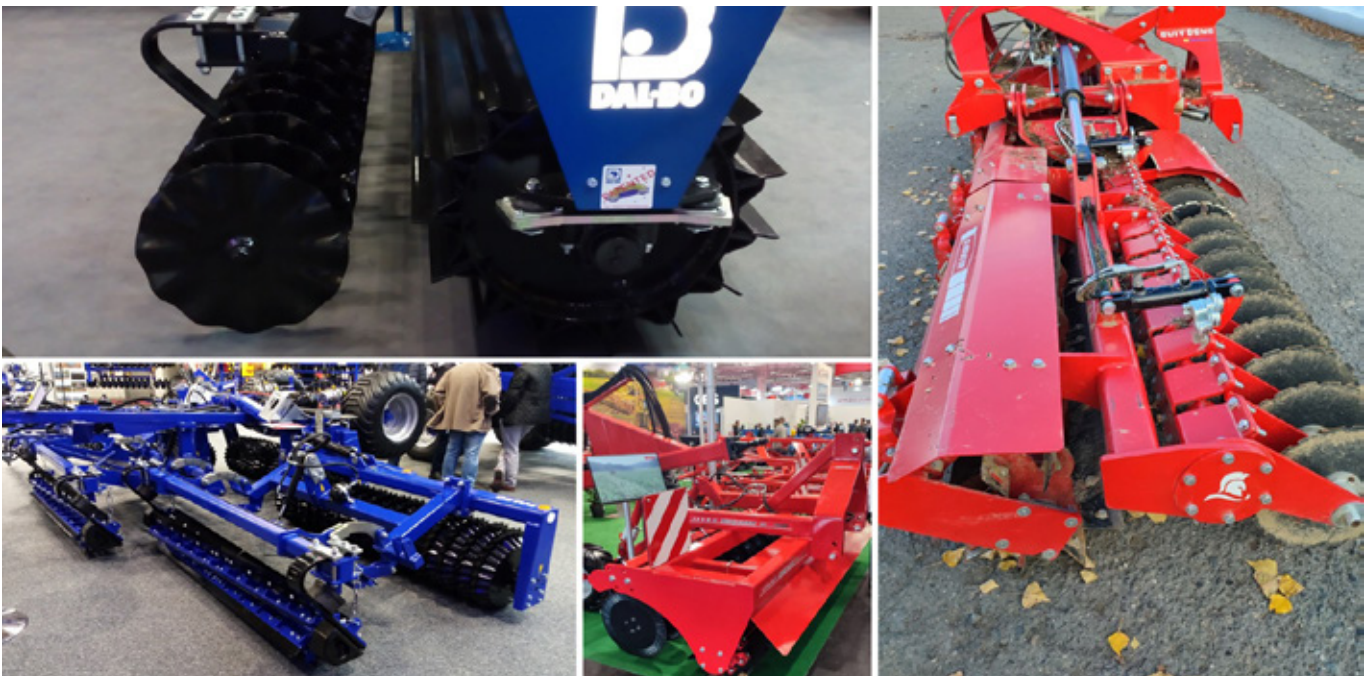
Obr. 263: Dostupná jsou i řešení kombinující řezné válce a další pracovní nástroje, jako jsou řezné disky či hvězdicové válce (foto Brant).
