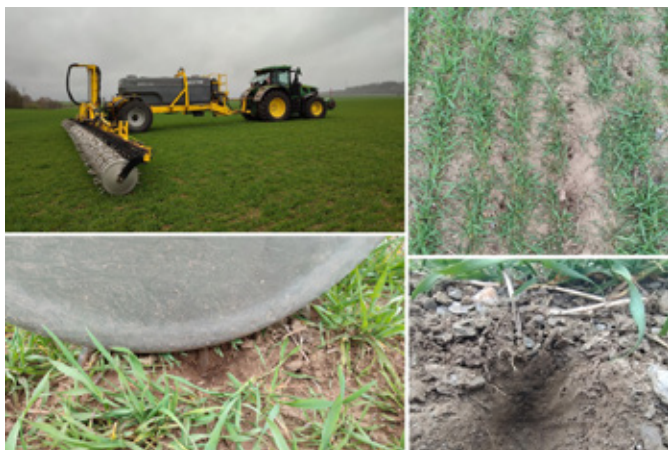
Obr. 333: Injektážní aplikace v porostech obilnin není spojena s poškozením porostů (foto Brant).
