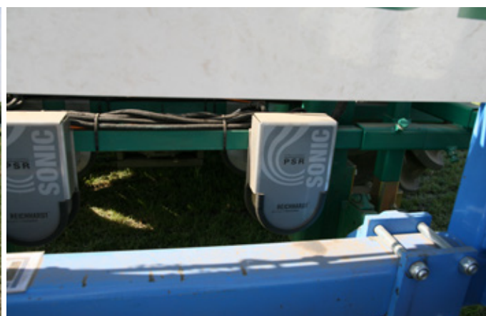
Obr. 394: Ultrazvukový senzor určený pro přesné vedení kultivátoru v meziřádku (foto Kroulík).
