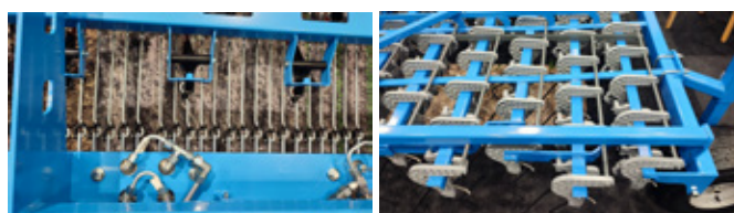
Obr. 283: Prutové brány jsou vybavovány systémy variabilního přítlaku (vlevo) a technickými řešeními pro individuální vyřazení prutů z aktivní pracovní polohy – vpravo (foto Brant).
