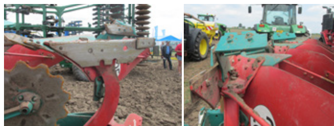
Obr. 67: Umístění podrýváku na orebním tělesem (foto Brant).
